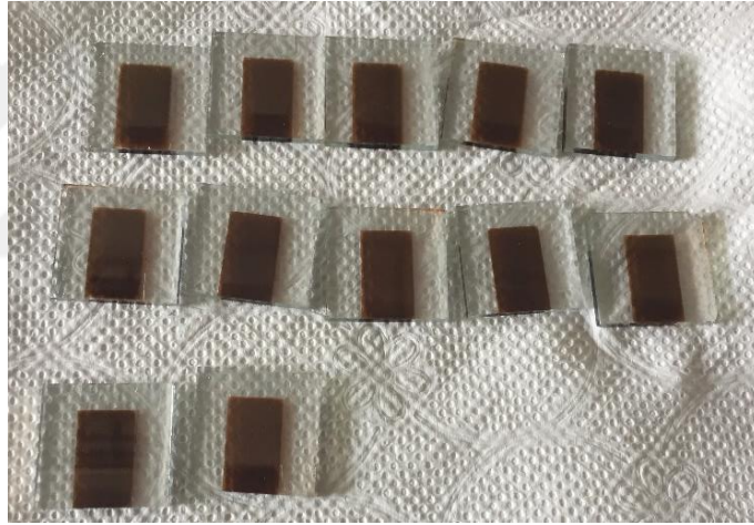
Şekil 3.17. FTO/TiO 2 /MA 3 Bi 2 I 9 kaplanan perovskit optik soğurucu tabakası
