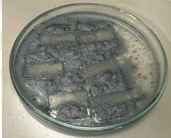
Şekil 3.13. FTO kaplı cam taban malzemeyi çinko tozuyla aşındırılması
