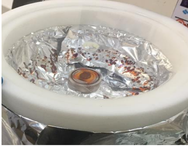
Şekil 3.18. Spin kaplama ile üretilen P3HT tabakası
