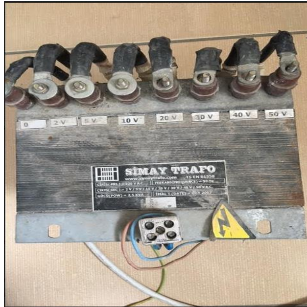
Şekil 5.8. Deney çalışmalarında kullanılan AC trafo
