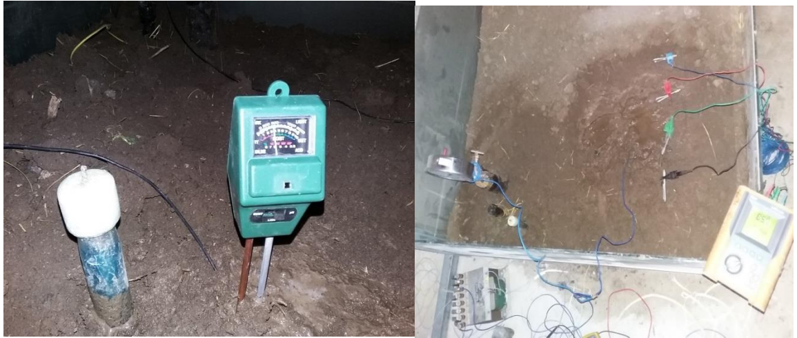
Şekil 5.11. Nemlilik seviyesinin ölçümü (a) zemin direnç seviyesinin ölçümü (b)
