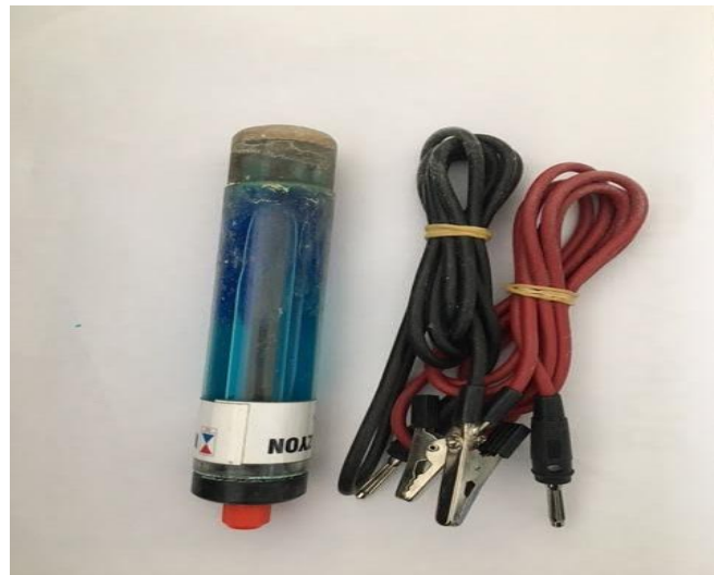
Şekil 5.7. Deney süresince kullanılan seyyar tip elektrotlar
