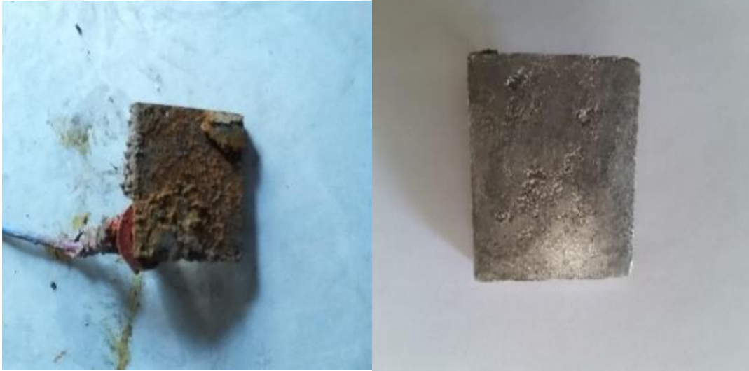
Şekil 5.4. Deney sonrası çıkarılan korozyon kuponu (a), deney sonrası temizliği yapılan korozyon kuponu (b).
