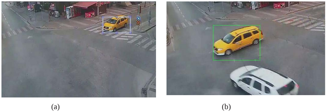
Şekil 3.2. (a) Hedefin ilk çerçevede manuel olarak seçilmesi, (b) Hedefin Blob analiz ile takip edilmesi
