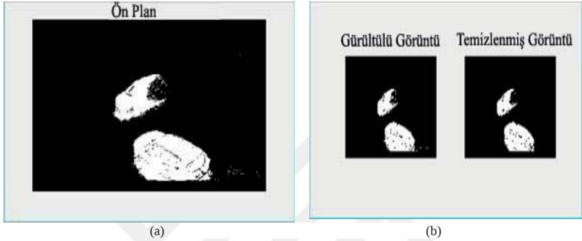
Şekil 3.3. Arka plan tespiti için morfoloji süreci (a) Ön plan görüntüsü, (b) Gürültü içeren arka plan görüntüsü ve filtre uygulanarak temizlenmiş görüntü
