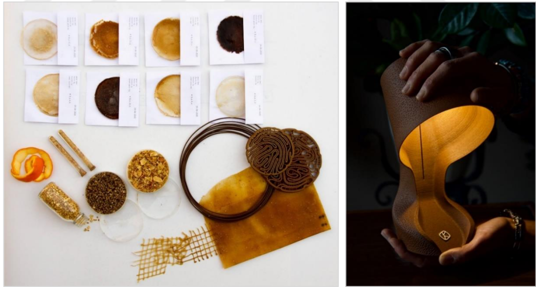
Şekil 42. Ohmie, 3B baskı tekniği ve portakal kabuklarından elde edilen biyoplastiklerin kullanımı ile üretilen lamba tasarımı ( https://www.dezeen.com/2021/07/19/ohmie-compostable-lamp-orange-peels/ Erişim: 15.06.2023)
