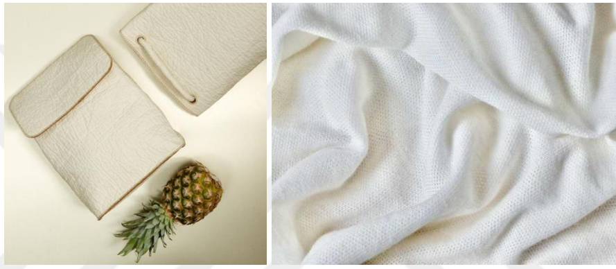
Şekil 58. Pinatex / Pinayarn, Ananas yaprakları kullanılarak üretilen biyoplastik deri alternatifleri ve ipliklerden üretilmiş kumaşlar ( https://www.ananas-anam.com/ Erişim: 15.06.2023)
