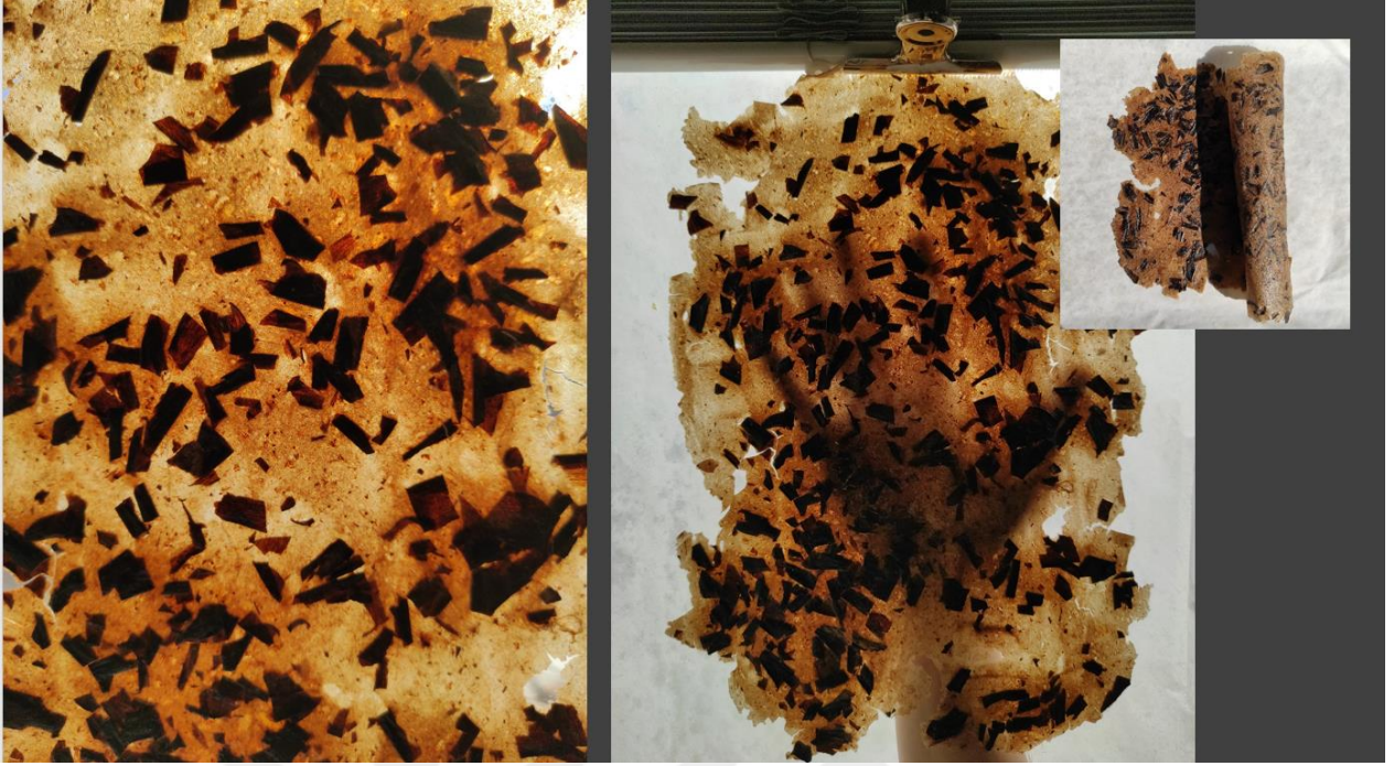
Şekil 96. Muzdan pişirme yöntemiyle elde edilmiş ilk dokusuz biyotekstil yapı numuneleri
