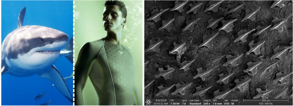
Şekil 9. (sol) Köpek balığı görseli ve Speedo tarafından köpek balığı derisinden esinlenerek tasarlanan yüzücü mayosu ( http://www.ecouterre.com/10-eco-fashion-garments-inspired-by-nature-and-biomimicry/2/ Erişim: 10.06.2023), (sağ) Köpek balığı derisinin yapısını gösteren SEM görüntüsü. (Fotoğraf: Biyobeta Biyobenzetim ve Biyotasarım çalıştayını kapsamında Ege-Matal laboratuvarında çekilmiştir, 2019)
