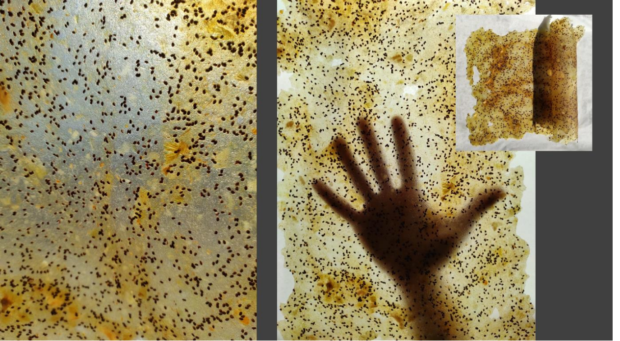
Şekil 95. Kividen pişirme yöntemiyle elde edilmiş ilk dokusuz biyotekstil yapı numuneleri
