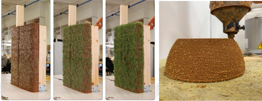
Şekil 41. 3B baskı tekniği ile üretilen hammadde olarak tohum içeren çamur kullanılan yaşayan duvar tasarımı ( https://parametric-architecture.com/university-of-virginia-3d-prints-living-structures-that-can-grow-plants/ Erişim: 15.06.2023)
