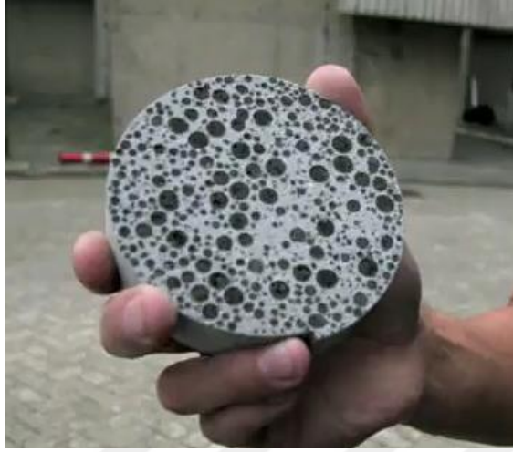
Şekil 34. Kendi kendini onarma özelliğine sahip biyobeton BioConcrete ( https://www.bdcnetwork.com/dutch-teams-bioconcrete-can-heal-itself Erişim: 15.06.2023)
