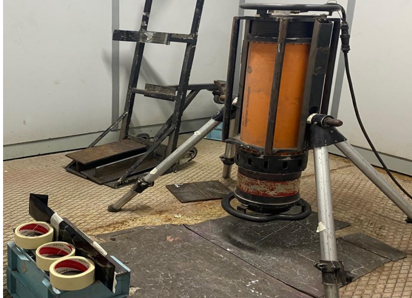
Şekil 3.8: Dijital Radrografi Çekim Düzenegi
