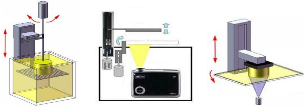
Şekil 2.3: a) DLP Yöntemi b) CDLP Yöntemi, c) SLA Yöntemi
