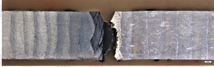
Şekil 4.14: Arayüzey Bölgesi Kırılma Yönü İncelenmesi
