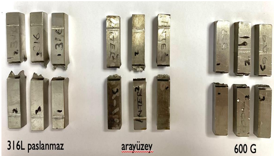
Şekil 4.11: Çentik Darbe Testi Sonrası Numune Görüntüleri
