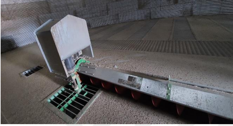
Ek Şekil 8. Dip sıyrıcı ile ilgili görüntüler
