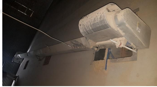
Ek Şekil 8. Dip sıyrıcı ile ilgili görüntüler
