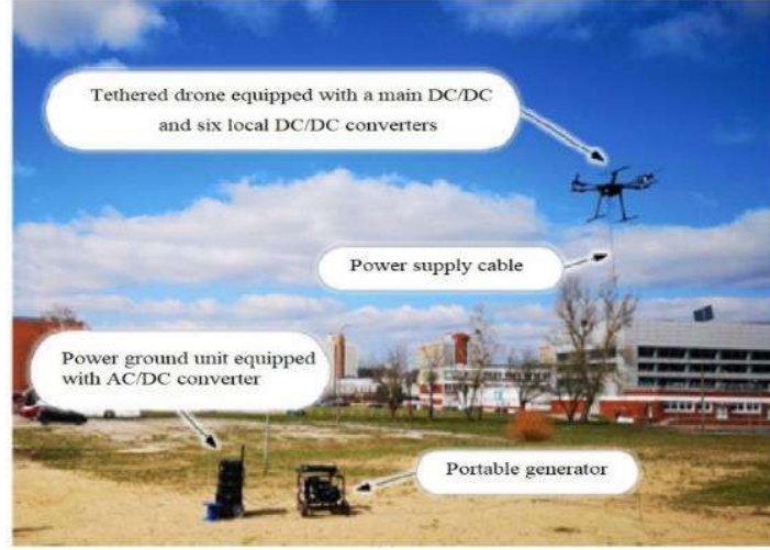
Şekil 2.10. Kablolü Güçlendirilmiş İHA'ların Bileşenleri ((Walendziuk et al. , 2020)'den alınmıştır)
