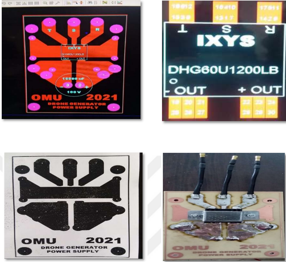
Şekil 4.15. Fazlı doğrultucunun 3 fazlı doğrultucunun PCB modeli ve devresi tasarımı
