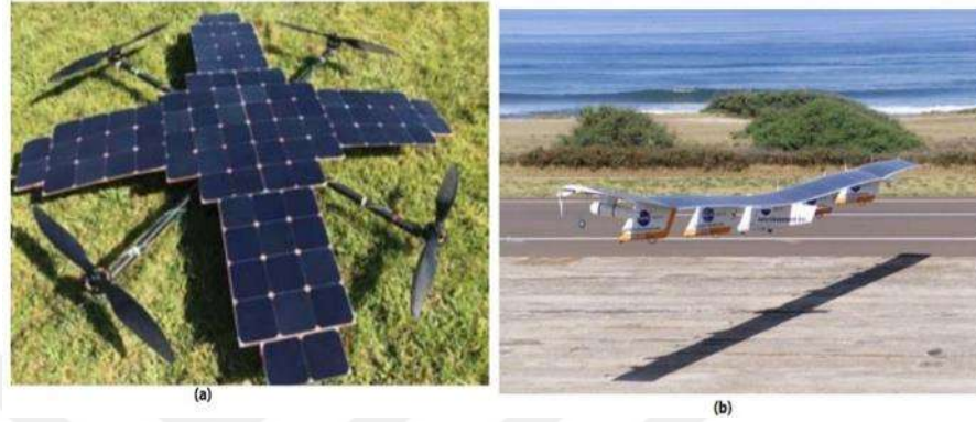
Şekil 2.6. (a) Güneş enerjisiyle çalışan bir quadcopterin yapısı (Goh et al. , 2019) ve (b) uçan kanat NASA'dan (Cravey et al. , 2006)
