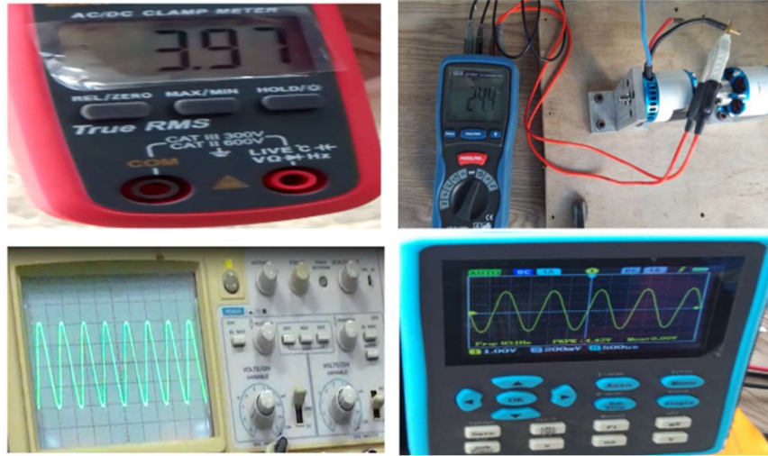
Şekil 4.34. EG'nin performans parametrelerinin deneysel sonuçları (sol üstten): yüksüz akım, iç direnç ve geri emf şekli
