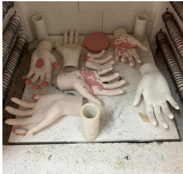
Görsel 30. Sır Fırının Yükleneşmesi
