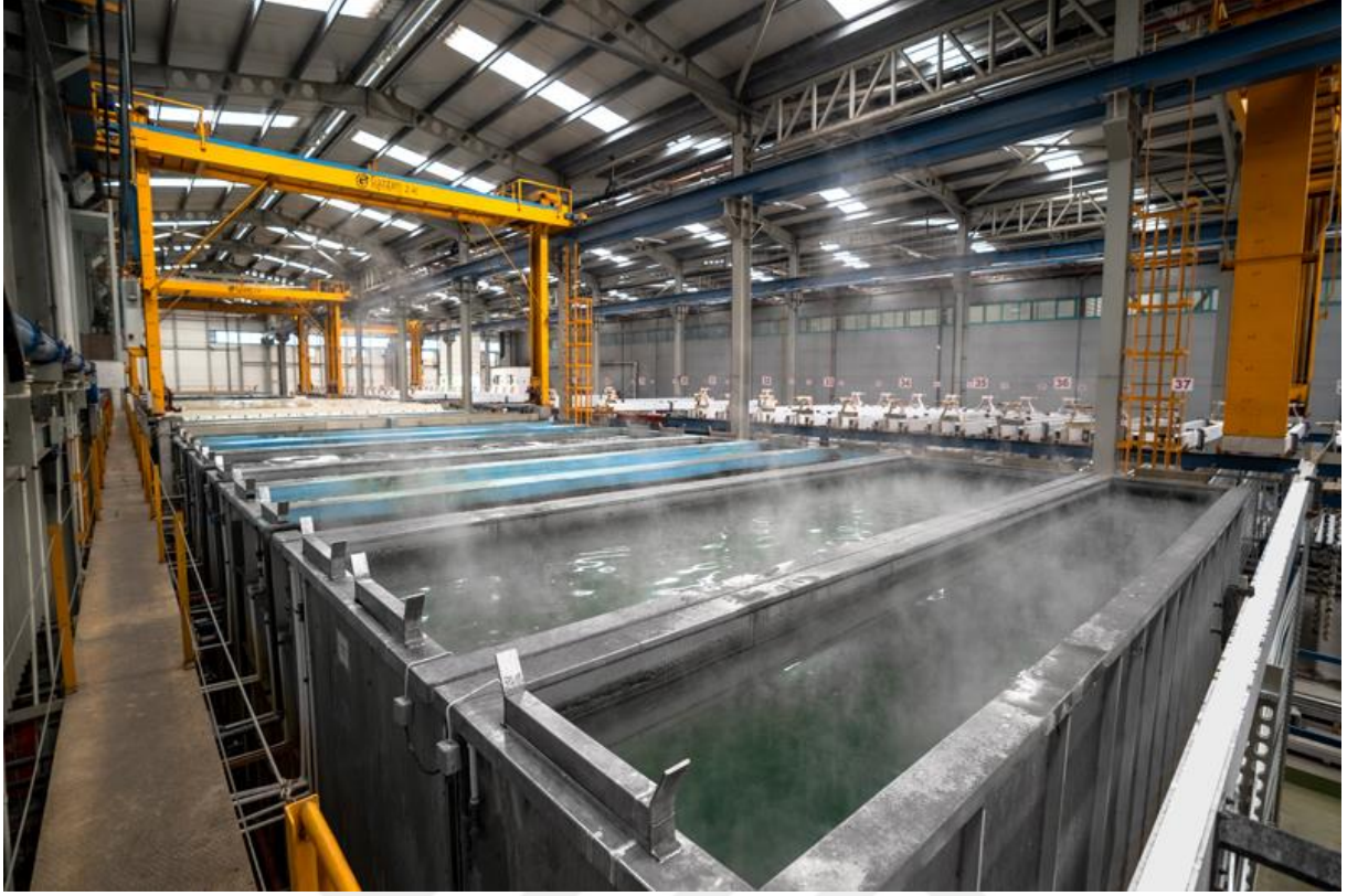
Şekil 2. 5. Endüstride Kullanılan Eloksal Kaplama Havuzu Örneği 8
