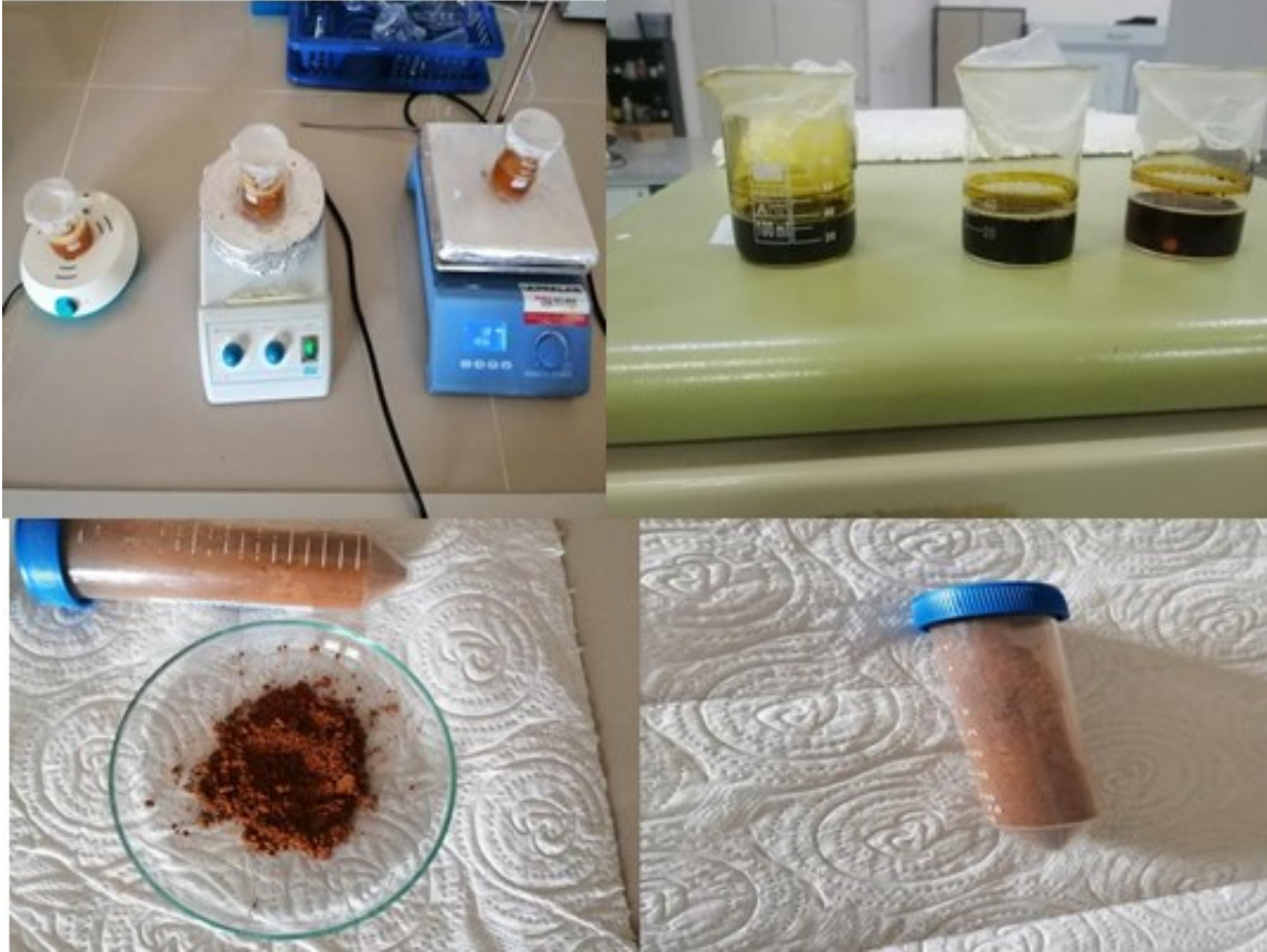
Şekil 3.4 Nanopartikül ekstralarının hazırlanışı
