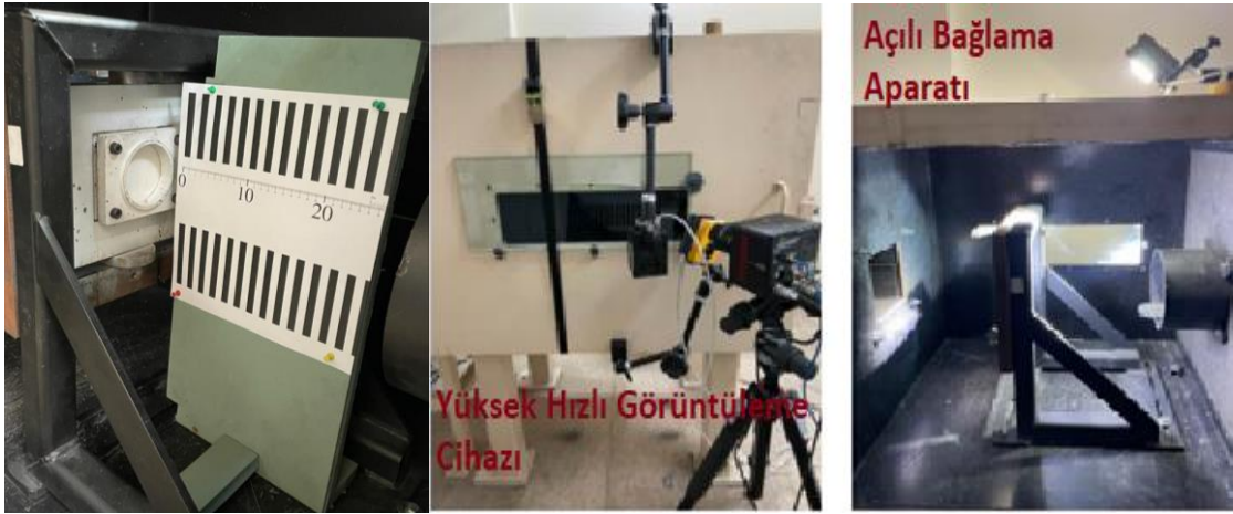
Şekil 2. 6. Balistik testlerde kullanılan yüksek hızlı kamera ve mermi çıkış hızı ölçümü
