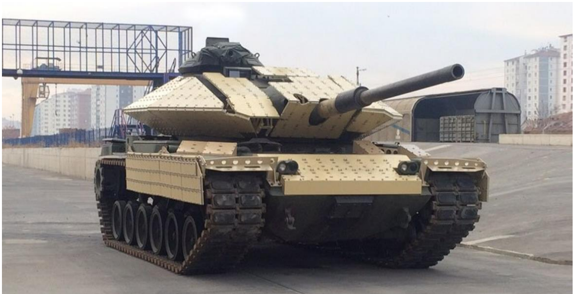
Şekil 1.21. Roketsan tarafından M60A3 tankları için geliştirilen ERA zırh paketi [38]
