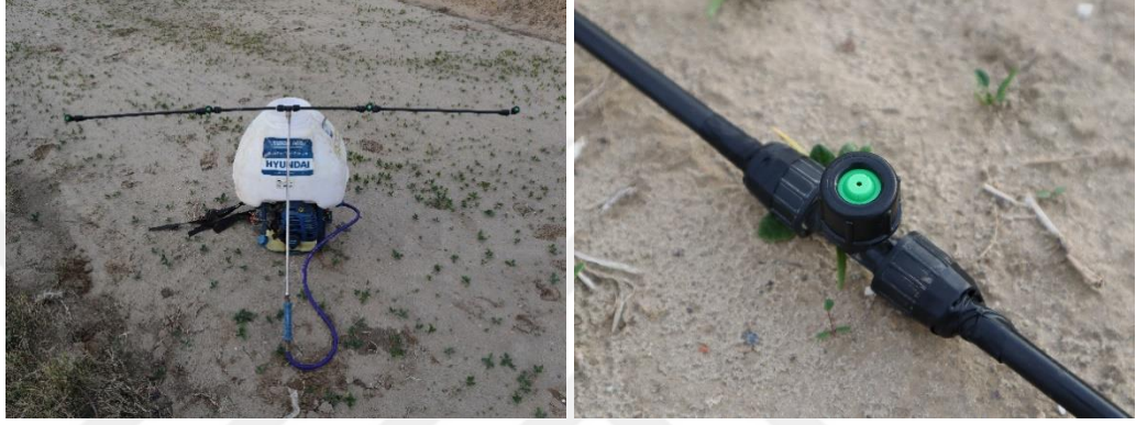
Şekil 3.1. İlaçlama makinasının detaylı fotoğrafları, a) Çalışmada kullanılan "Hyundai FST 900" sırt pülverizatörü ve "T" bum b) Konik tipi meme.
