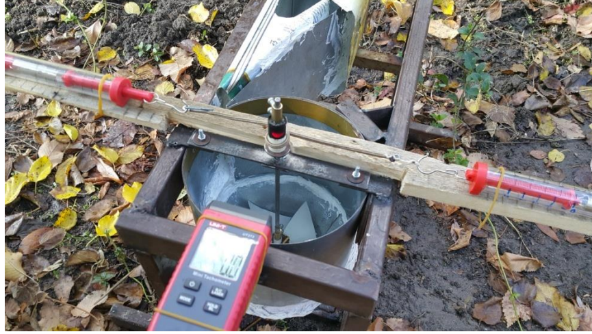
Şekil 4.48. Takometre Lazer Noktasının Deneme Düzeneği Kasnağı Üzerinden Devir Bilgisini Alması
