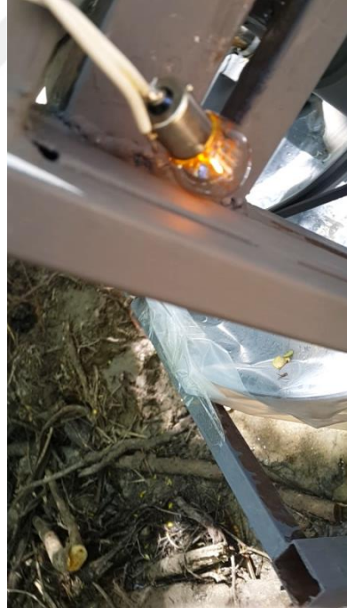
Şekil 4.56. Alternatör, Çıkışlarına Bağlanan 21 W, 12 V Ampule 3 V Gerilim ve 0,86 A Akım Vermektedir.
