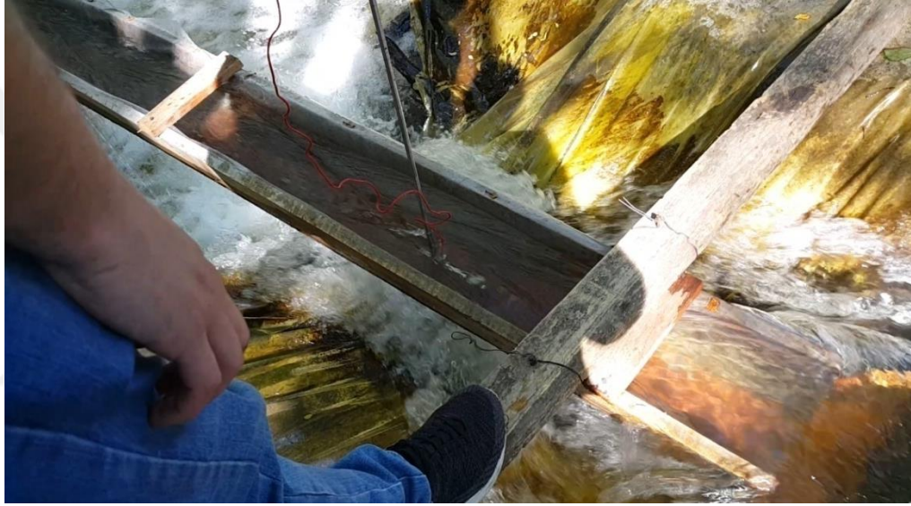
Şekil 4.51. Cüce Muline Cihazı Probu İle Kanaldaki Suyun Hızının Ölçülmesi
