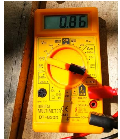
Şekil 4.56. Alternatör, Çıkışlarına Bağlanan 21 W, 12 V Ampule 3 V Gerilim ve 0,86 A Akım Vermektedir.
