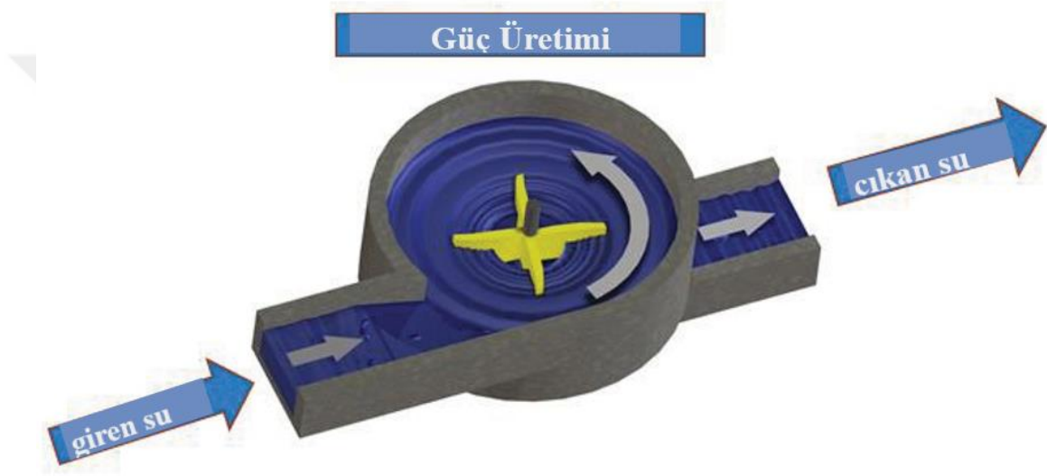
řekil 2.15. Silindirik Hazneli Bir Girdap Trbininin alıřma Prensibi
