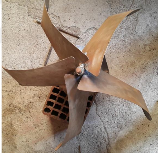
Şekil 4.34. 1 mm Sac Malzemedan İmal Edilen Prototipin Türbinin Pervane Kısmı (Üstten Görünüm)
