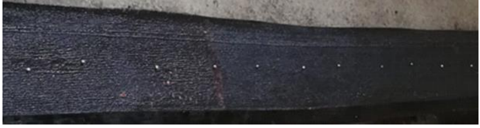
Şekil 3. 15. Tek dane ekimde akış sıra üzeri tohum dağılım düzgünlüğü denemesi
