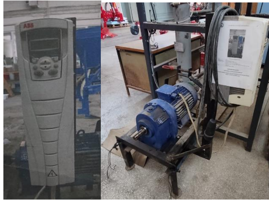
Şekil 3. 9. Vakum sağlamada kullanılan frekans konvertörü ve elektrik motoru
