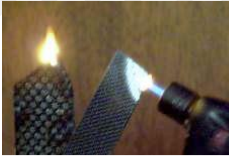
Şekil 2.20. Karbon-epoksi kompozit (solda) yanarken, karbon-geopolimer kompozit (sağda) 1200 °C'lik ateşe direnmekte (Davidovits, 2002)
