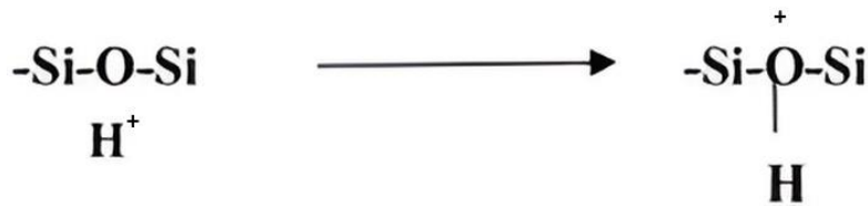
Şekil 2.14. Fosfat bazlı geopolimer sürecinin ilk adımı (Tchakouté ve diğ., 2017)
