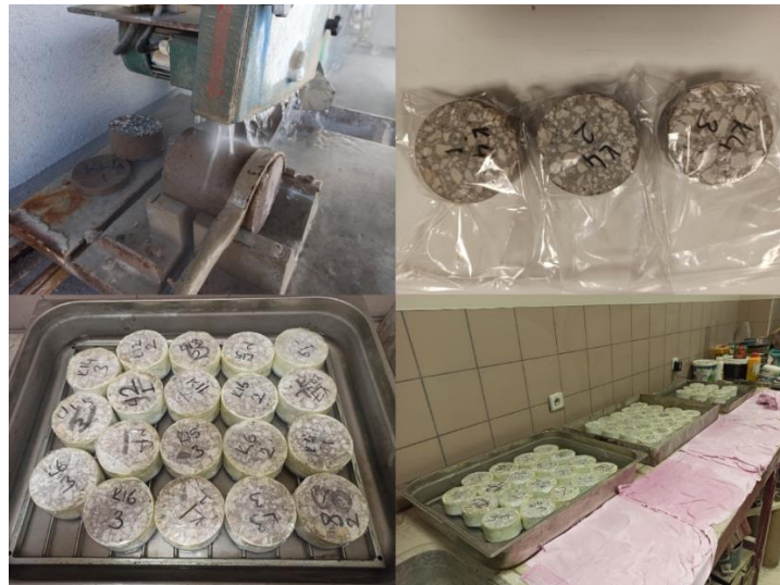
Şekil 4.17. Kılcal su emme deneyi aşamaları
