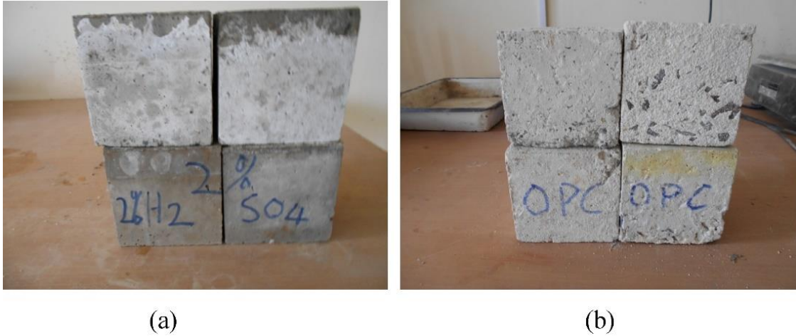
Şekil 2.29. a) GPB3 b) PÇB'lerin 90 gün süre ile %2 sülfirik asit çözeltisine bırakılan betonların görünüşleri (Okeye ve diğ., 2017)
