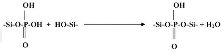
Şekil 2.16. Si-O-P-O-Si bağların kondensasyon süreci (Tchakouté ve diğ., 2017)
