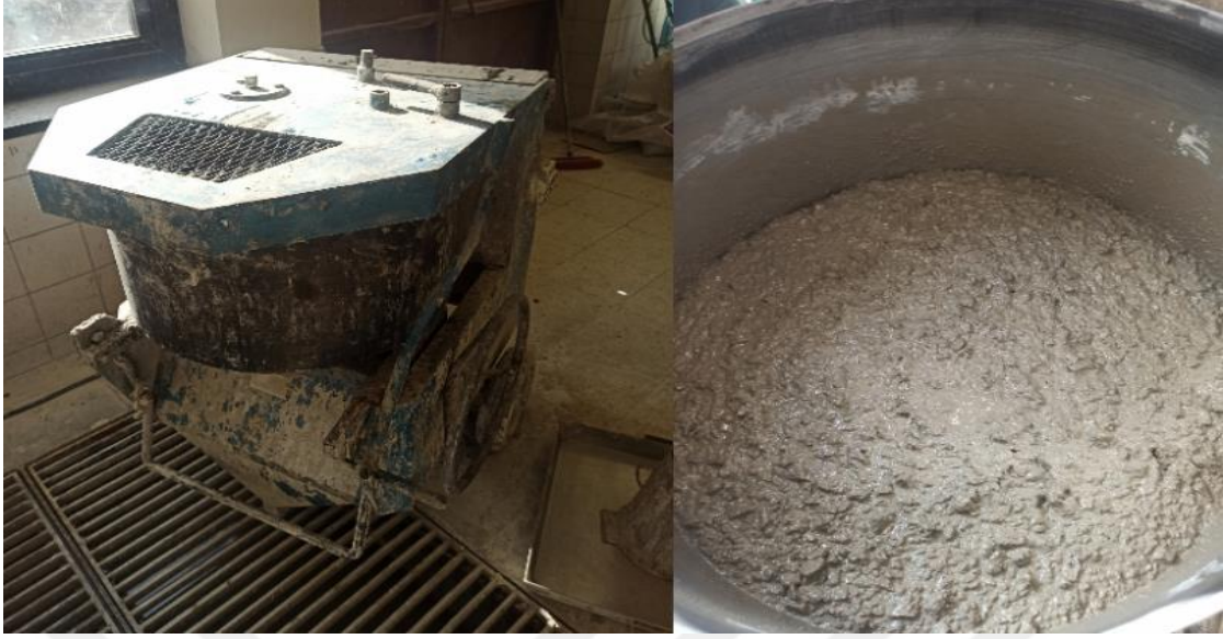
Şekil 4.10. Beton karışım mikseri ve geopolimer beton görünümü
