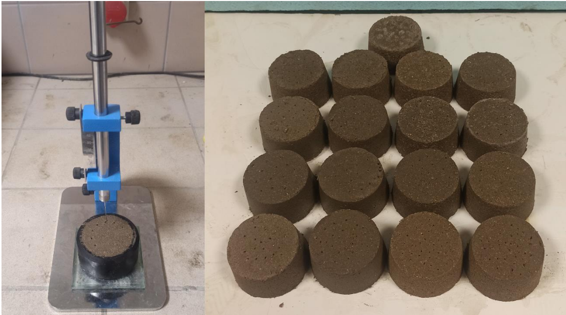
Şekil 4.12. Priz deneyi ve üretilen numuneler
