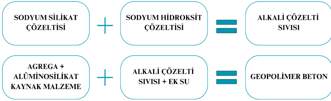
Şekil 2.22. Geopolimer beton üretim aşamaları
