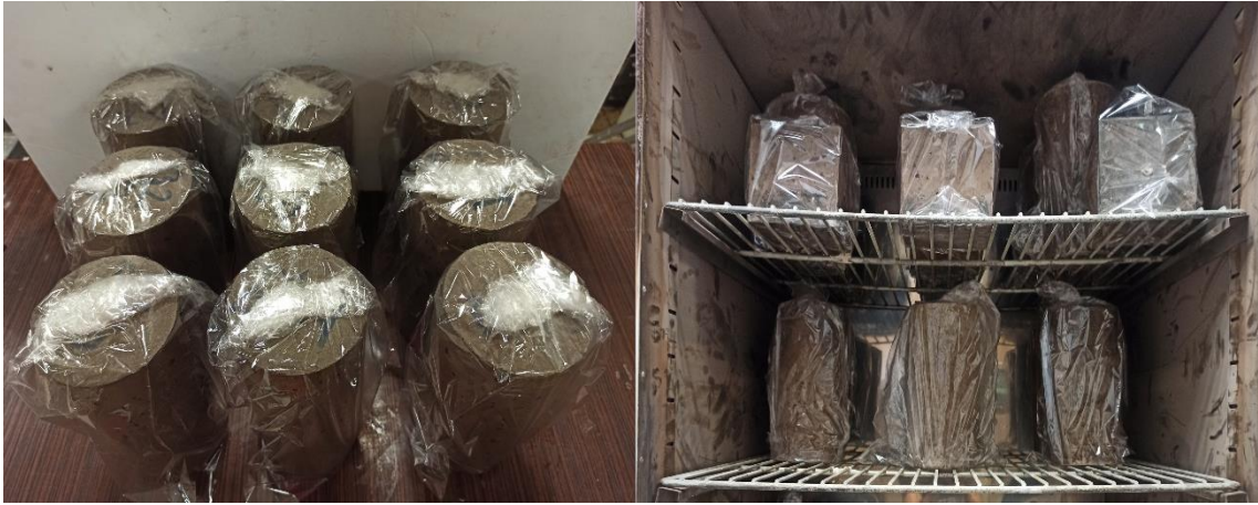
Şekil 4.11. Isıl kuru kürlleme işlemi
