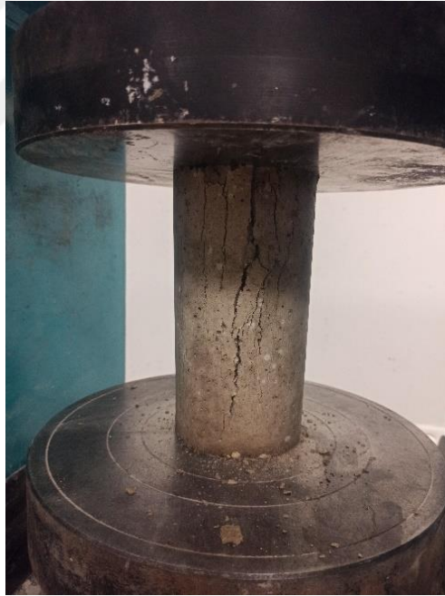
Şekil 4.15. Basınç dayanımı deneyi
