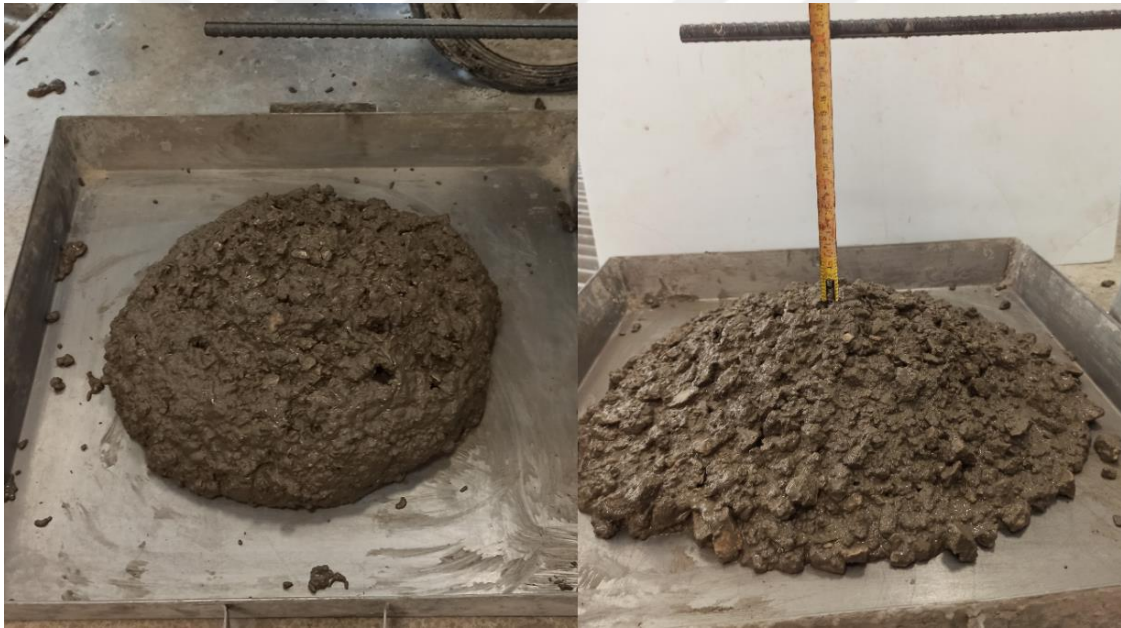
Şekil 4.13. Taze geopolimer beton slump deneyi
