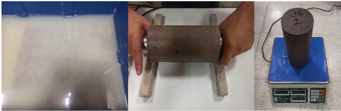
řekil 4.19. Magnezyum sülfat deneyi yapılıřı
