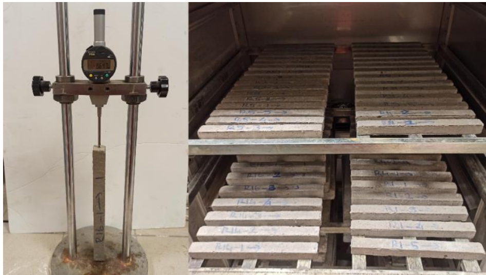
Şekil 4.20. Rötre deneyi ve üretilen numuneler
