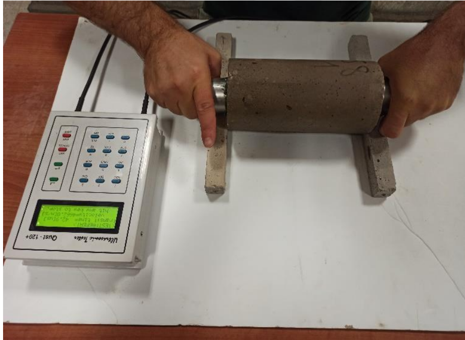
Şekil 4.14. UPV (m/s) deneyi
