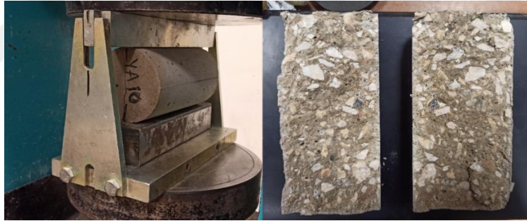
Şekil 4.16. Yarmada çekme dayanımı deneyi
