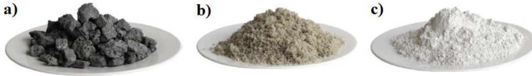
Şekil 2.2. Farklı üretim süreçleri sonucu YFC'ler a) Genleştirilmiş YFC, b) Granüle YFC, c) Öğütülmüş YFC (URL-1).
