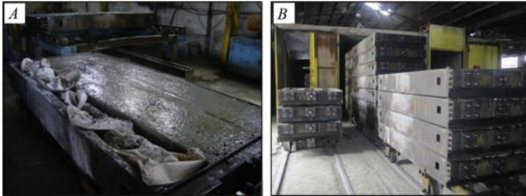
Şekil 2.39. Geopolimer traversler A) Döküm sonrası, B) Buharla kürleme (Shojaei ve diğ., 2015)
