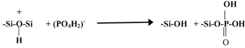
Şekil 2.15 Silanol ve silisyum-fosfat bağların oluşum süreci (Tchakouté ve diğ., 2017)
