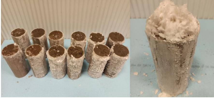
Şekil 4.8. Çiçeklenme oluşumu gösteren geopolimer betonlar
