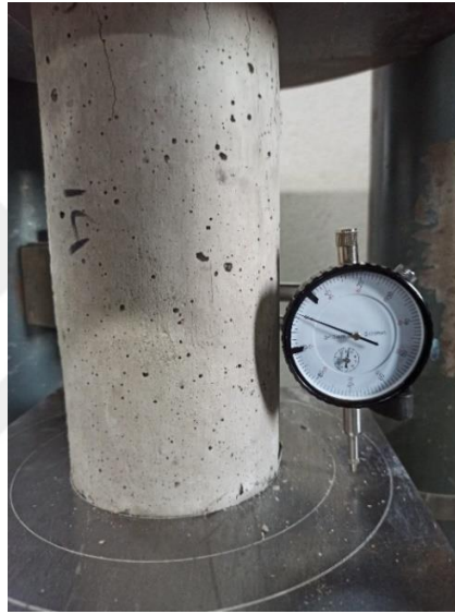
Şekil 4.18. Statik elastisite deneyi düzeneği
