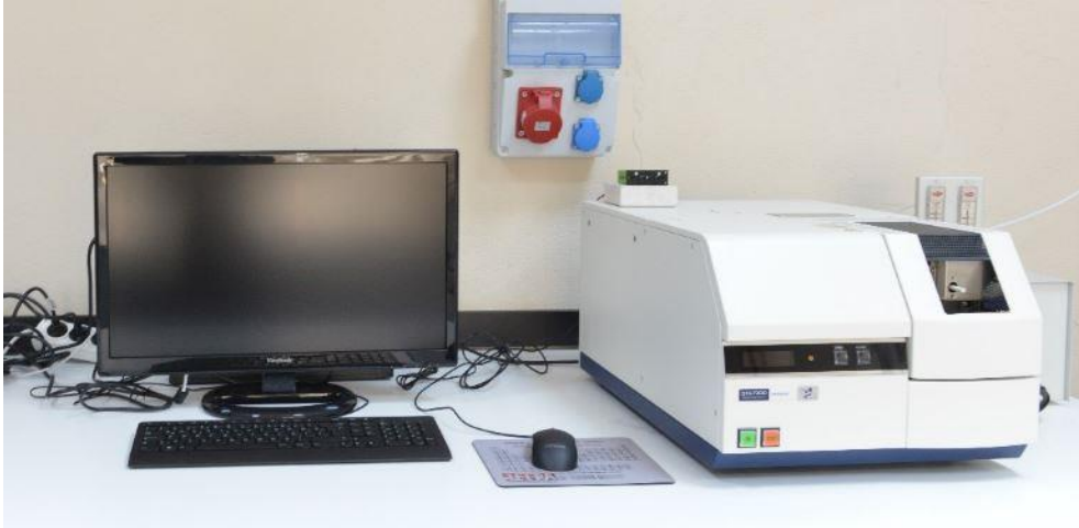
Şekil 3.4. HITACHI STA 7300 marka termal analiz cihazı.
