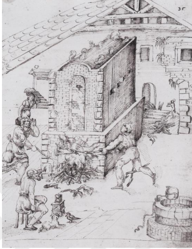
Resim 2.24. Mayolika fırınının yakılması, sol ön plandaki fırın ustasının fırının sıcaklığını değerlendirmesi (Wilson, 2013:7).
