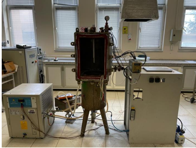
Şekil 8.1: Kapalı atmosferde, florür esaslı elektrolitler ile gerçekleştirilecek ETE sistemi.
