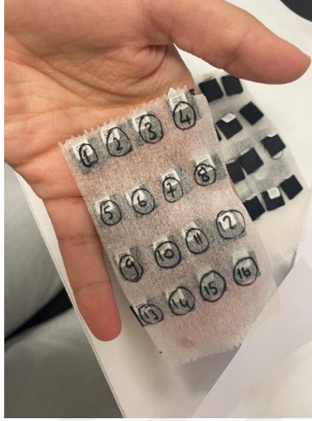
Resim 5.10. OSL karışıklığını önlemek için hazırlanan bant görüntüsü
