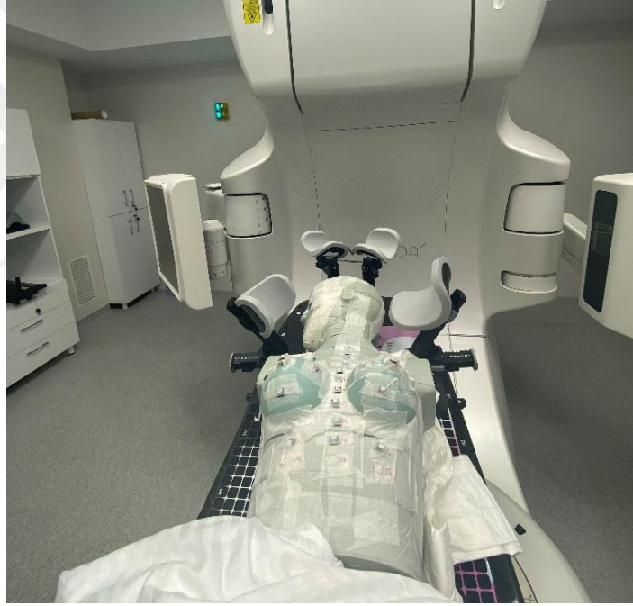
Resim 5.11. TrueBeam STx cihazında OSL ışınlama görüntüsü
