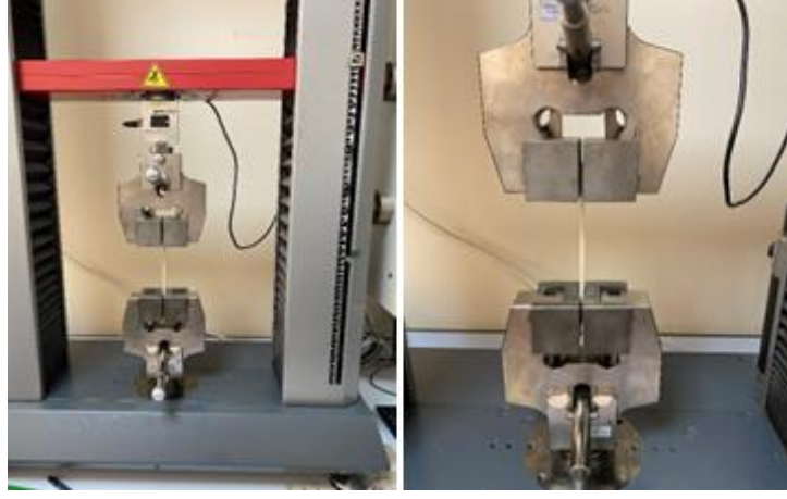
Şekil 3.7: Çekme direnci testi (Fotoğraf: Gülyaz AL, 2021)
