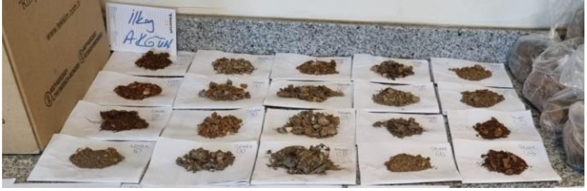
Şekil 3.8. Tartılarak Alınan 100gr lık Numuneler
