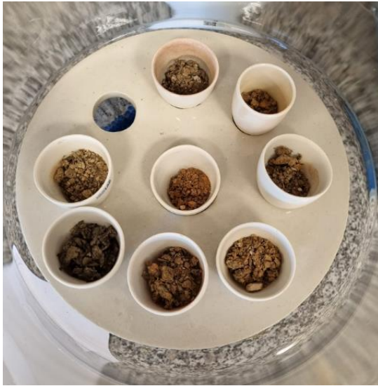
Şekil 3.5. Kül analizi için numunelerin ayrılması
