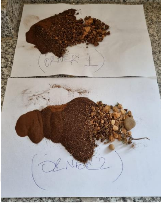
Şekil 3.10. Elek analizi işlemi sonrası numunelerin görünümü
