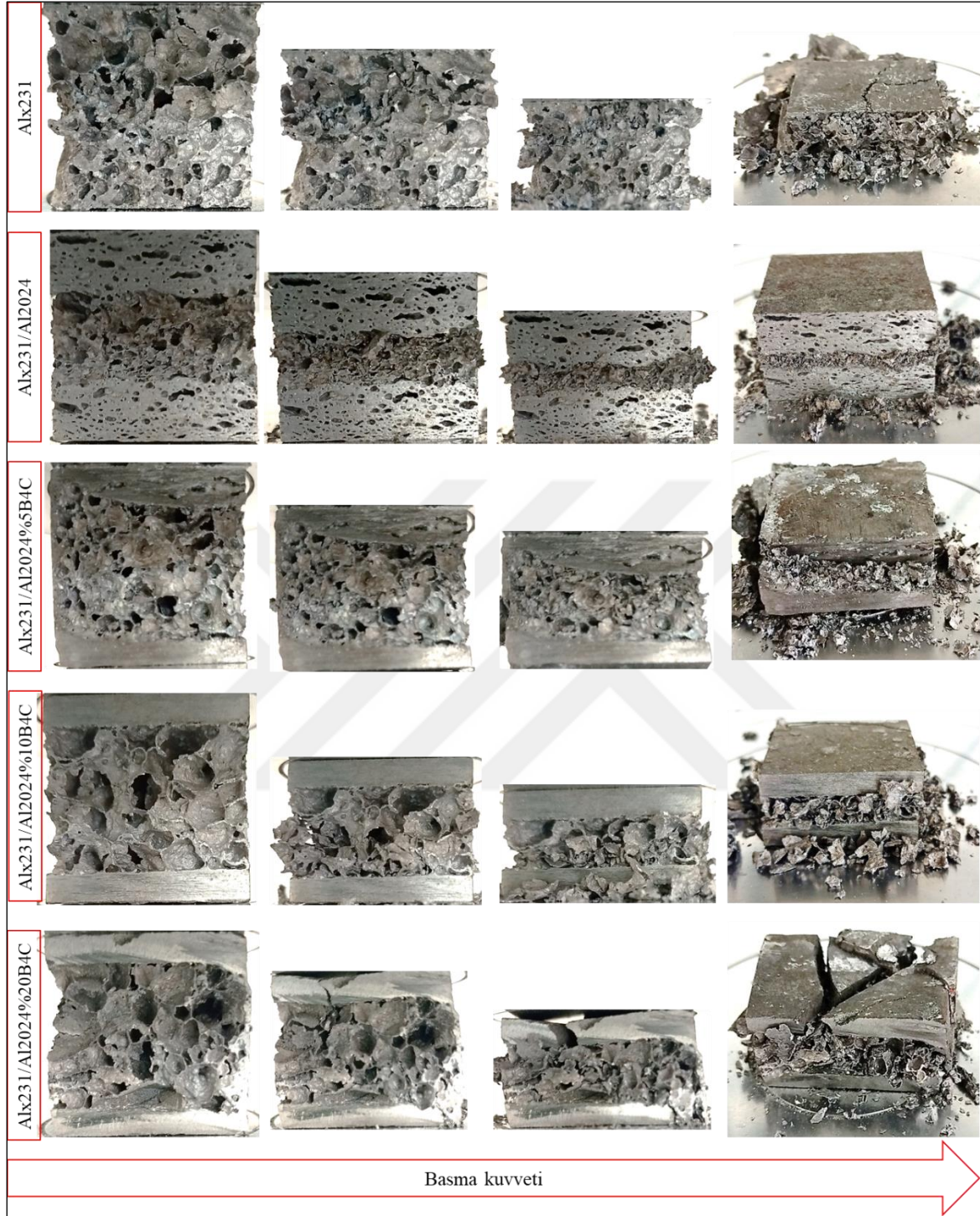
Şekil 5.9. Metalik köpük numunelerin basma test deneyleri
