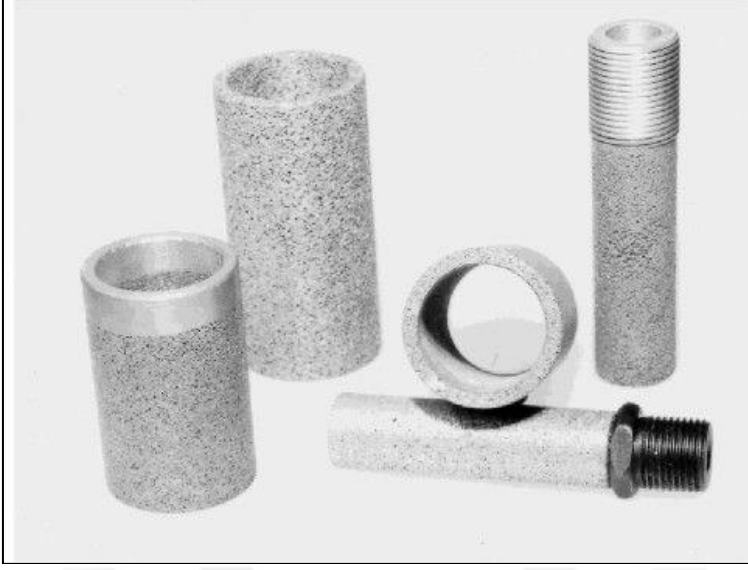
Şekil 3.18. Alüminyum köpükten yapılan susturucu (Kara, 2012)
