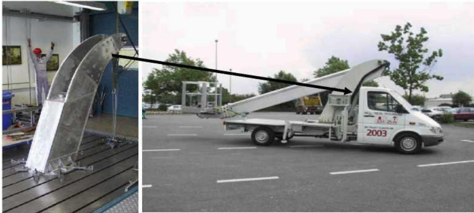
Şekil 3.12. Alüminyum sandviç panelden yapılmış bir kaldırma kolu (Banhart, 2003)
