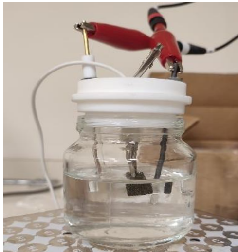
Şekil 3.9. Elektrokimyasal çalışmalarda kullanılan üçlü elektrot sistemi
