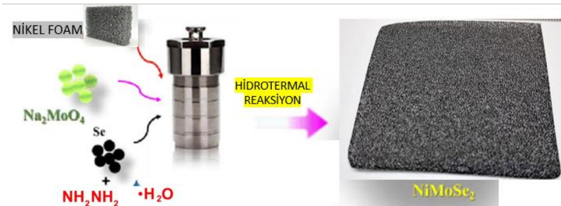
Şekil 3.5. Hidrotermal yöntem ile MoSe 2 sentezi ve NF modifikasyonu
