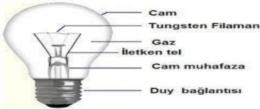
Şekil 2. Ampulün yapısı
