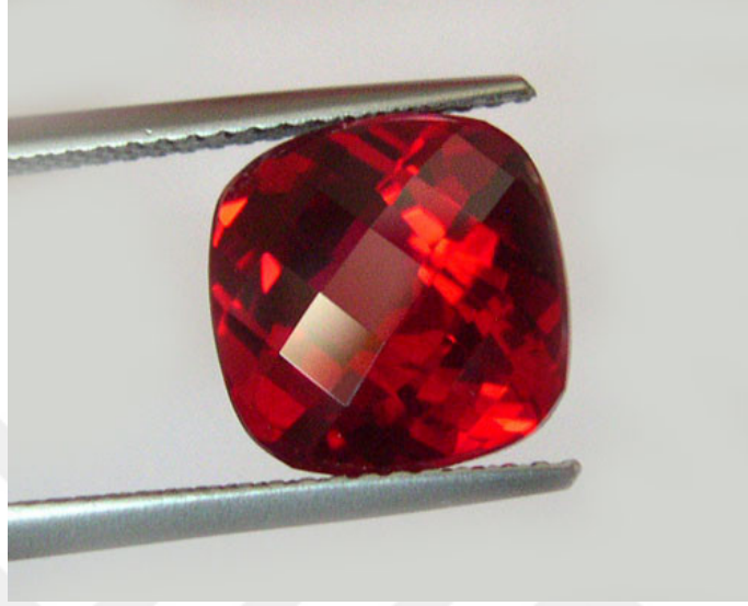
Şekil 3.25: Verneuil'in Yöntemi ile Sentetik Şekilde Üretilmiş Bir Yakut
