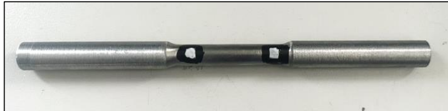
Şekil 6.4. Çekme Testi İçin Hazırlanan Çubuğun Makro Görüntüsü
