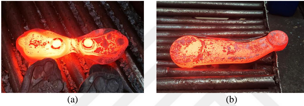
Şekil 6.1. Sıcak Dövme Sonrası a) Rotil (C45) b) Pitman Kolu (42CrMo4)
