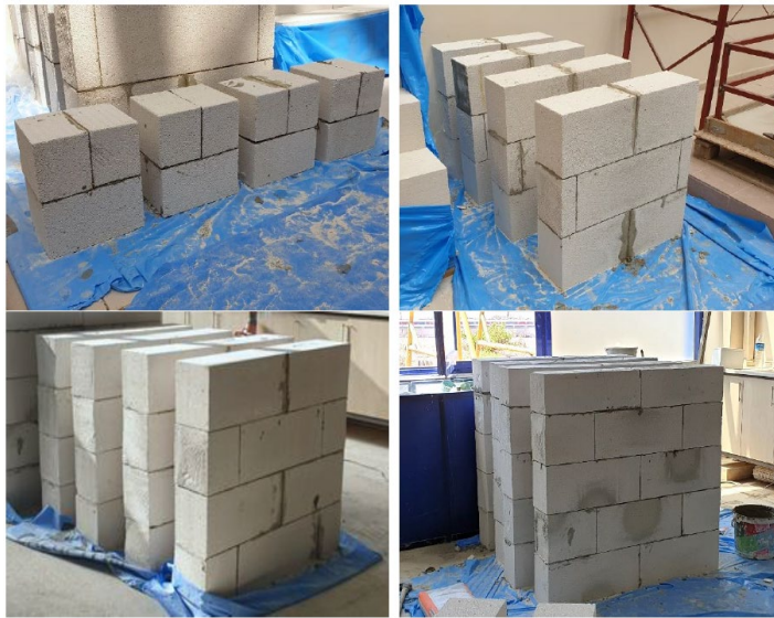
Şekil 4.2. Hazırlanan duvar numuneleri (Sabahoğlu 2022)
