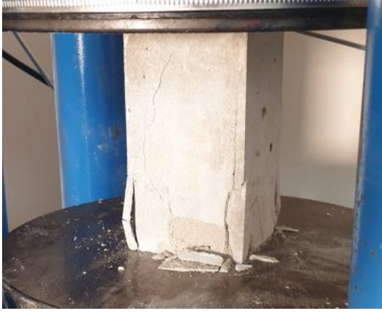
Şekil 4.1. Harç numuneleri üzerinde basınç testleri (Sabahoğlu 2022)
