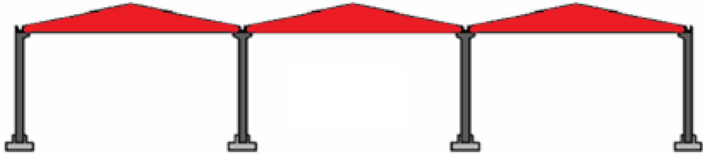
Şekil 3.1: Tipik tek katlı prefabrik yapının örnek gösterimi
