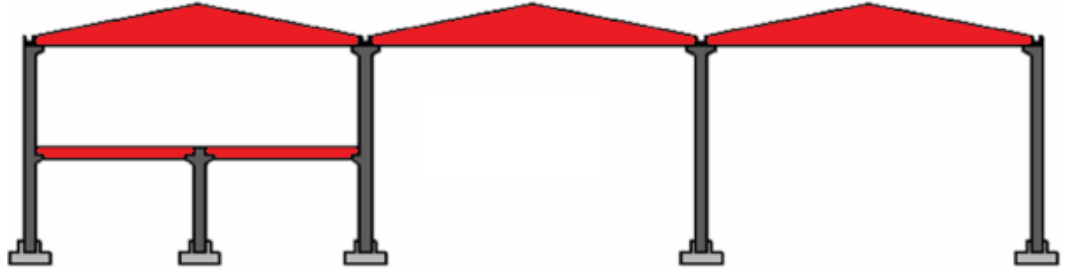
Şekil 3.3: Tipik karma prefabrik yapının örnek gösterimi
