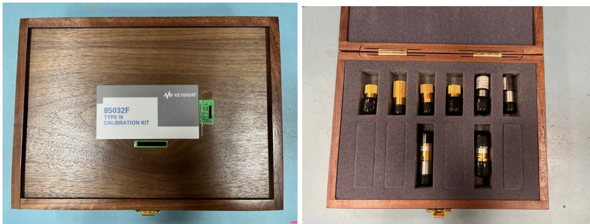
Şekil 6.2. Vektör ağ analizörünün iki portlu kalibrasyonu için kullanılan kalibrasyon kiti
