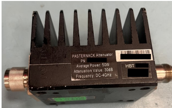
Şekil 6.1. Yansımaya ve iletim katsayısı ölçümünde kullanılan VNA (a) ve zayıflatıcı (b)
