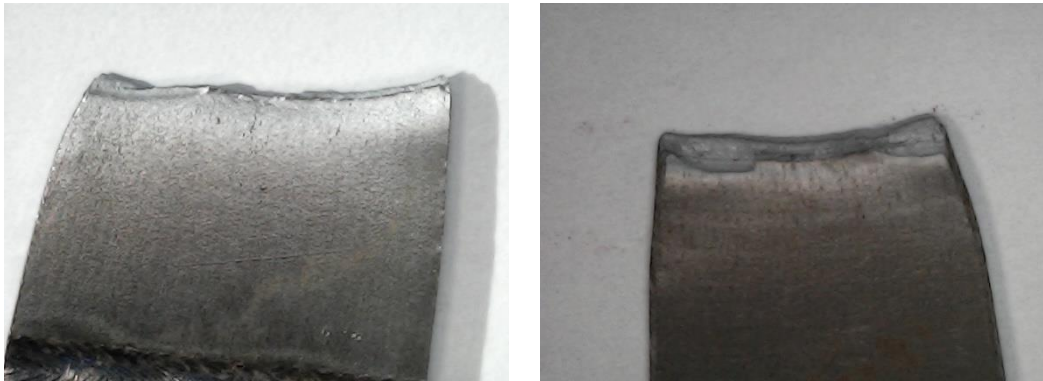
Şekil 6.41. Kırılma görüntüleri soldaki görsel DP600-HSLA LWAC sağdaki görsel DP600 LWAC.
