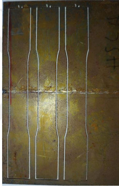
Şekil 5.4. Lazer kaynaklı saclardan çıkartılan numunelere ait gösterim ve görseller.
