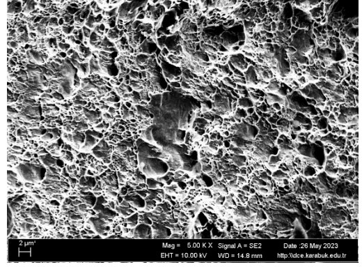
Şekil 6.49. Kırılma SEM görüntüleri DP600 BMC.
