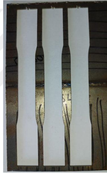
Şekil 5.4. Lazer kaynaklı saclardan çıkartılan numunelere ait gösterim ve görseller.
