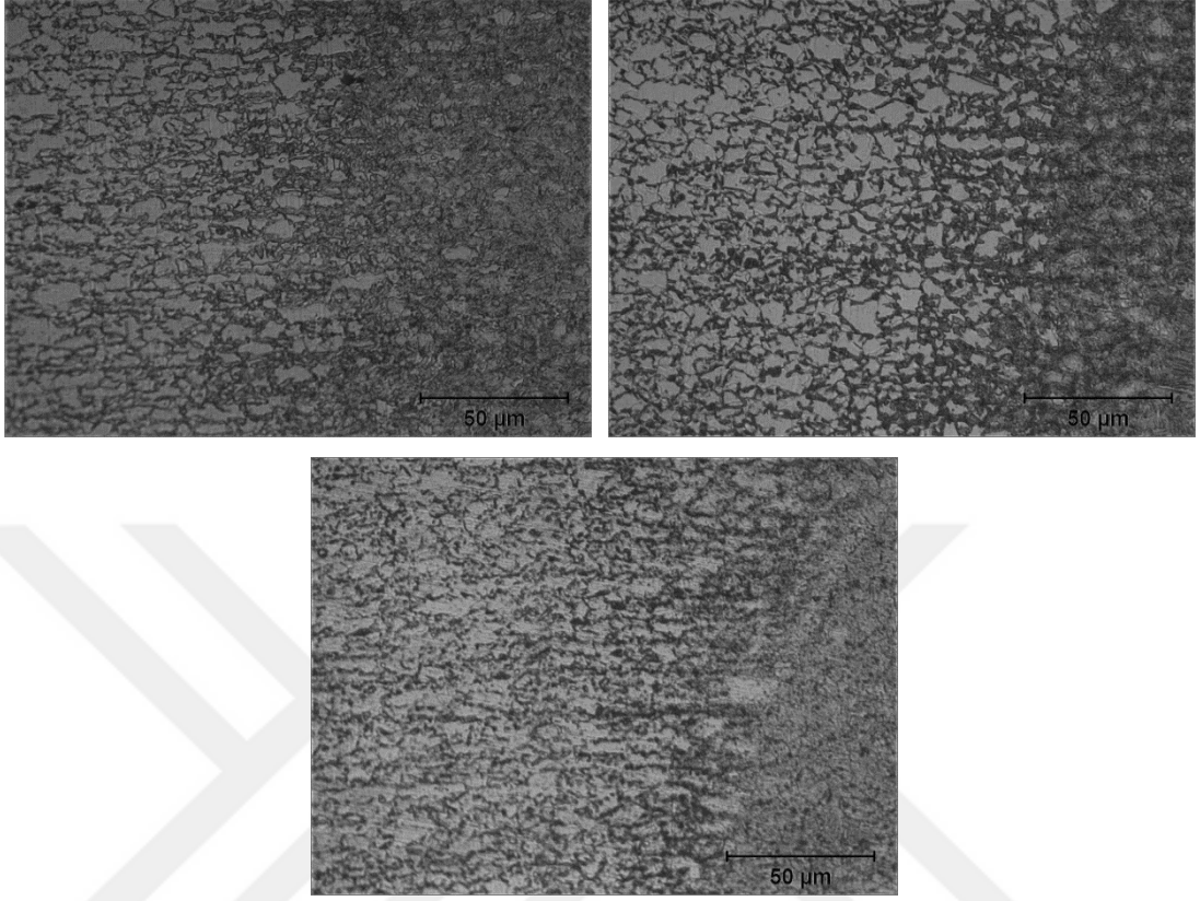
Şekil 6.13. DP600 çeliğine ait sırasıyla ITAB geçişleri a)LW, b) LWBC, c) LWAC OM görüntüleri
