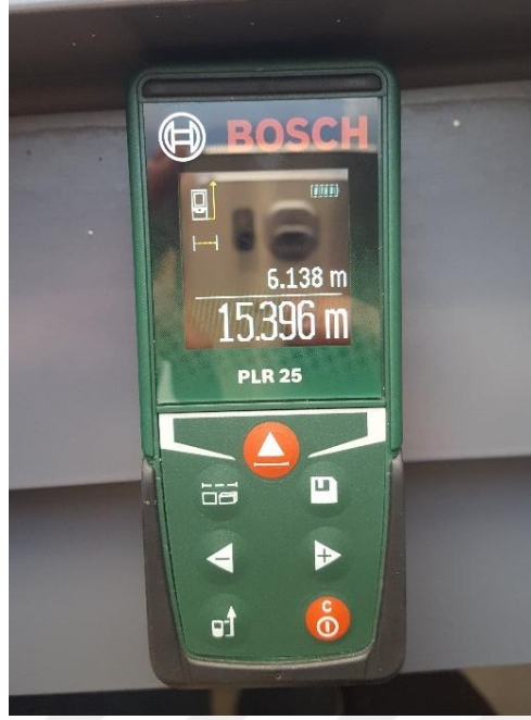
Resim 5.5.2.: Lazer mesafe ölçer ile 3.kattan yapılan yükseklik ölçümü
