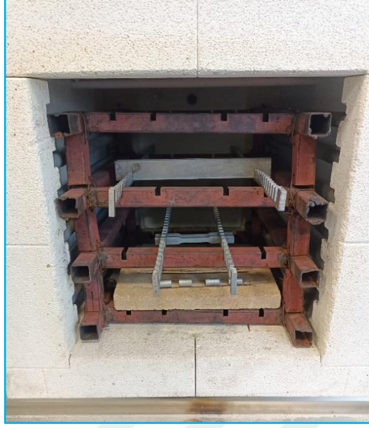
Şekil 3.12: T6 ısıt işlemler optimizasyonu çalışmasının yapıldığı ısıt işlemler fırını
