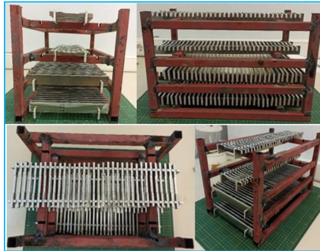
Şekil 3.11: Tasarlanan platforma deney numunelerinin yerleştirilmiş hali
