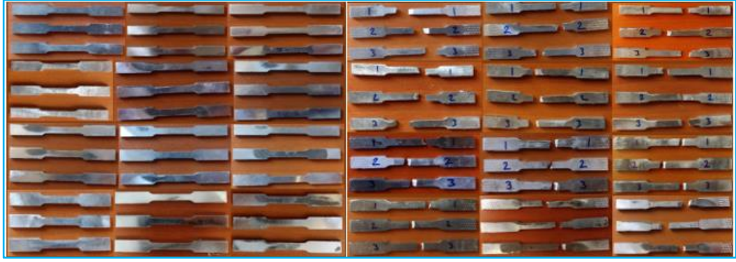
Şekil 3.34: Çekme testi öncesi ve sonrası numunelerin durumları
