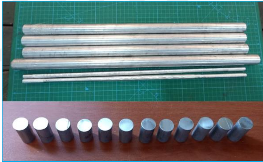
Şekil 3.7: Çubuk alüminyum alaşımları ve aşınma numuneleri
