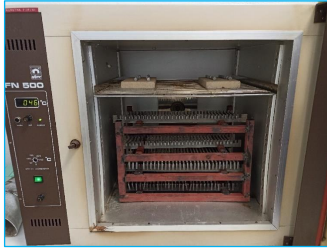
Şekil 3.16: T6I4 ısıt işleminin AA2024 ve AA7075 alaşımlarına uygulanması
