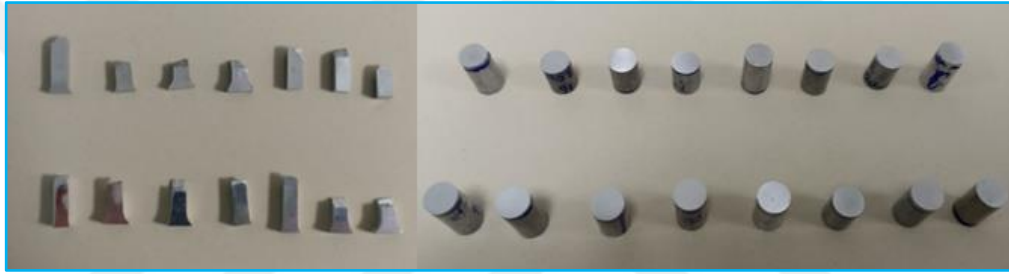
Şekil 3.25: Seçilen çekme ve aşınma SEM numuneleri
