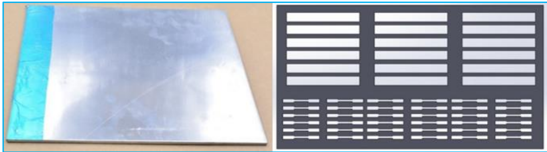
Şekil 3.4: Levha üzerinden çekme ve üç nokta eğme numunelerinin çıkarılması
