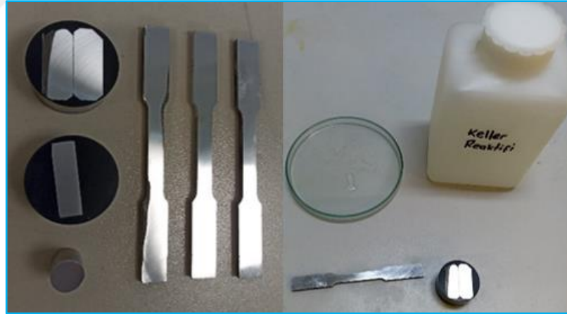
Şekil 3.21: Parlatılmış numuneler ve dağlama işlemi
