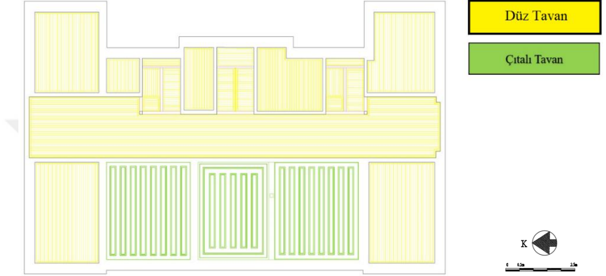
Görsel 100. Köşkün zemin kat planı üzerinden tavan işlemlerinin gösterimi (Yapı Merkezi: Z. Ayşe Güngör (Akyl), 19 Aralık 1999 tarihli restitüsyon projesinden yararlanılarak Sadık Çağrı Bildiş tarafından düzenlenmiştir).
