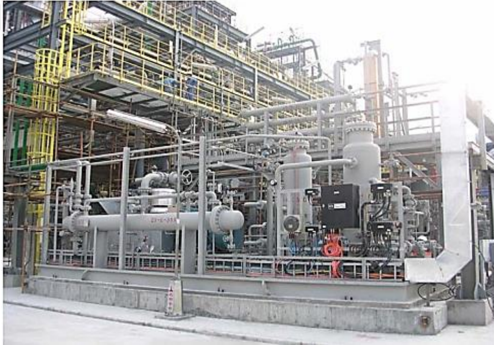
Şekil 8.2 Modern bir tesiste kurulu, membran prensibi esasına dayanan polipropilen geri kazanım sisteminin fotoğrafı [57]
