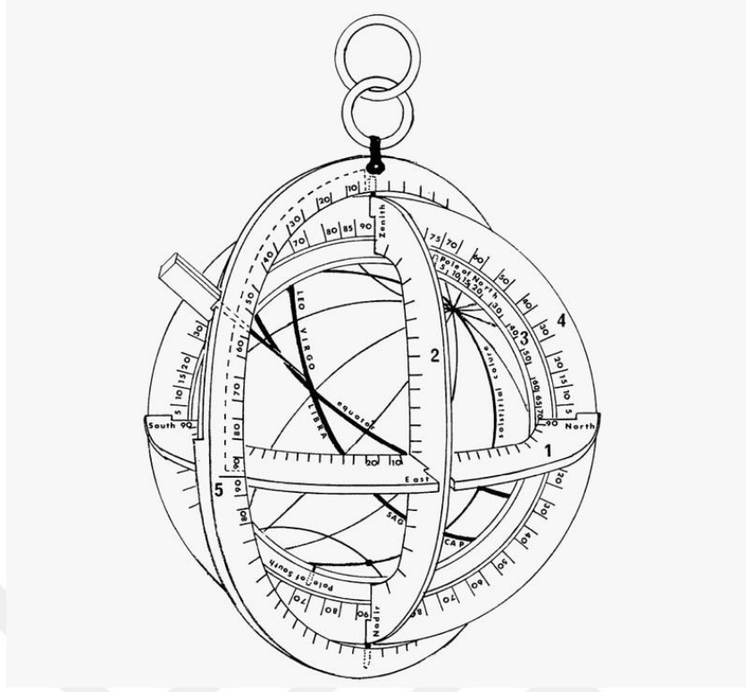
Resim 3. Bettānī'nin küre dizaynı. 1. ufuk halkası, 2. zenit halkası, 3. hareketli meridyen halkası, 4. sabit meridyen halkası, 5. gnomonu taşıyan dış halka (Savage-Smith ve Belloli, 1985: 21).
