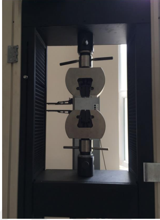
Şekil 3.8. Utest Universal marka çekme deneyinin yapıldığı cihaz
