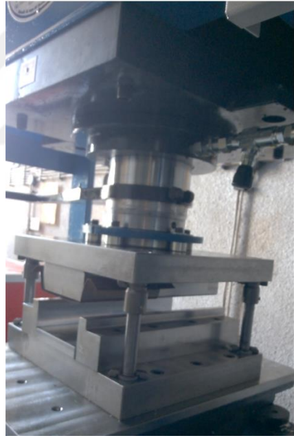
Şekil 3.2. U-profil kalıbına sahip hidrolik pres makinası
