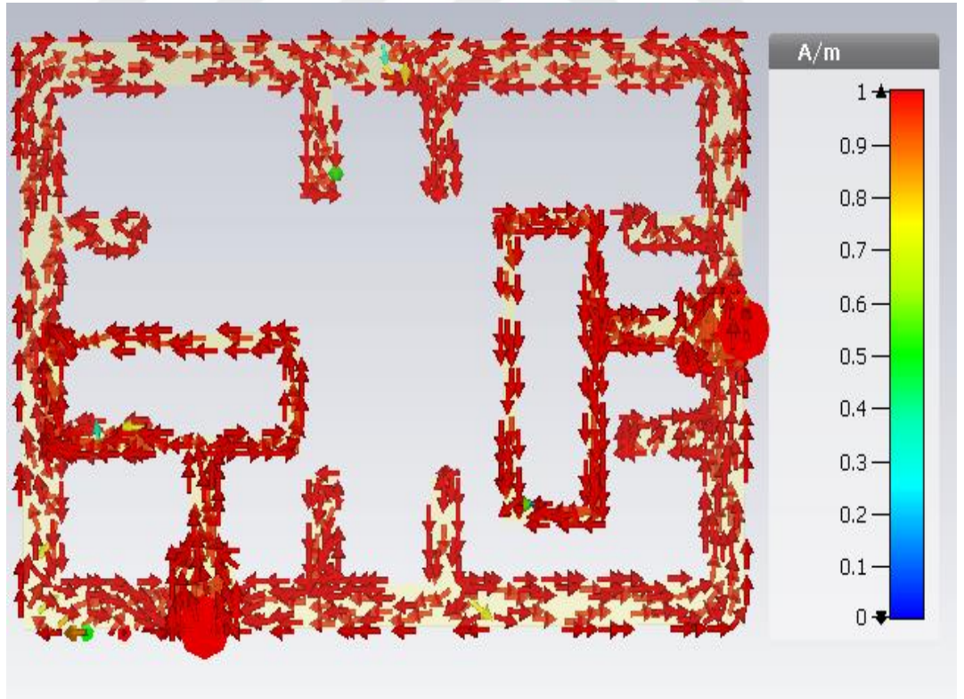
Şekil 5.18 Anten 3'e 3,5GHz'deki yüzey akım yoğunluğu
