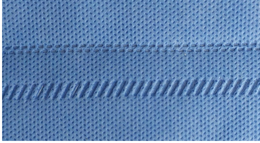
Şekil 24. Rollerların oluşturduğu dikim şekilleri
