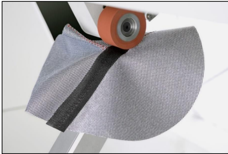
řekil 21. Bant kaynak iřlemi ( http://www.pfaff-konfeksiyon.com.tr/ )
