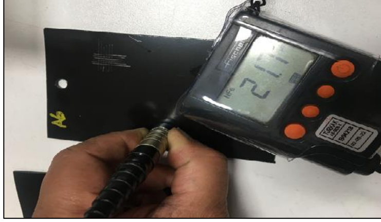
Şekil 4.9: Al plaka kaplama kalınlık ölçümü.
