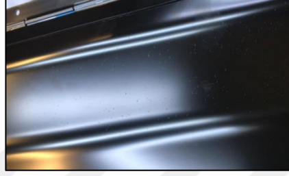
ekil 5.24: Sac plakada gzlenen hata trleri: apaklanma.
