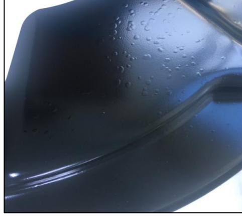
Şekil 5.22: Sac plakada gözlenen hata türleri: boya kabarması.
