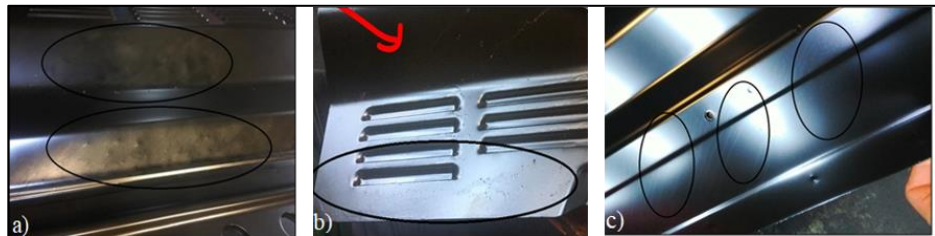
Şekil 5.27: Sac plakada gözlenen hata türleri: a) UF lekesi 1. b) UF lekesi 2. c) UF lekesi 3
