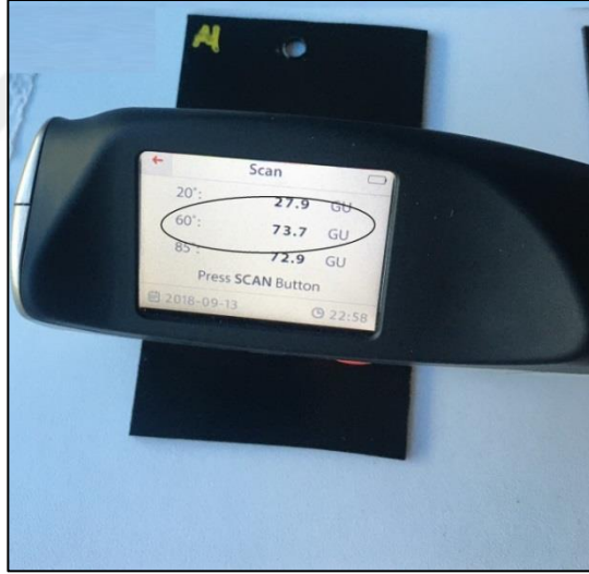
Şekil 4.10: Al plaka parlaklık ölçümü
