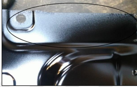
Şekil 5.28: Sac plakada gözlenen hata türleri: Yanma.
