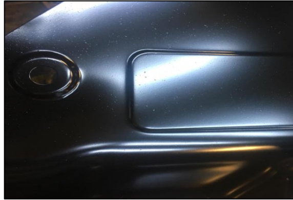
ekil 5.25: Sac plakada gzlenen hata trleri: manyetiklenme.
