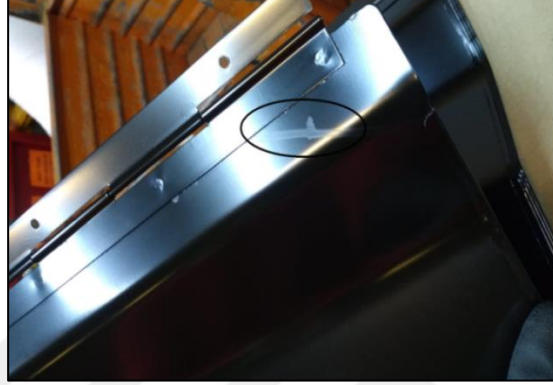
Şekil 5.26: Sac plakada gözlenen hata türleri: sepet akıntısı.
