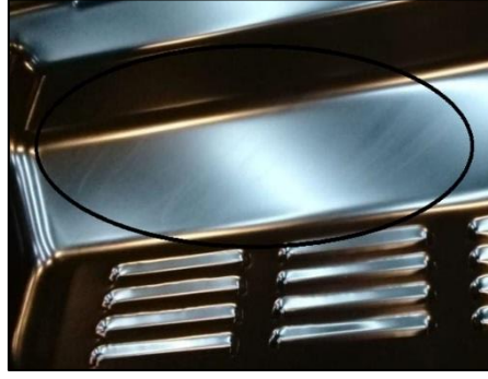
Şekil 5.29: Sac plakada gözlenen hata türleri: Asit lekesi.
