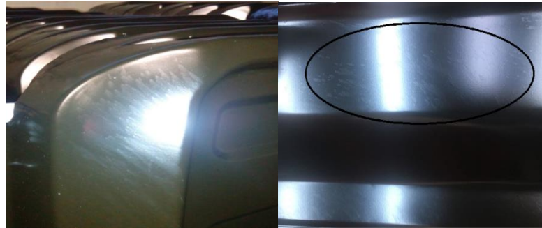
Şekil 5.23: Sac plakada gözlenen hata türleri: pas görünümü.
