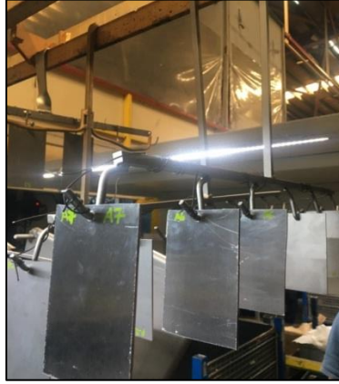
Şekil 4.5: Kaplama öncesi Al plakaların askılanması
