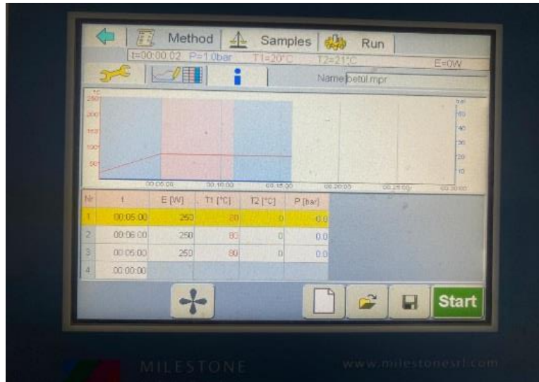
Şekil 3.4. Mikrodalga destekli ekstraksiyon koşulları
