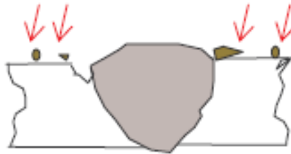
Şekil 2.11. Sıçrantı hataları (Askaynak, 2007)
