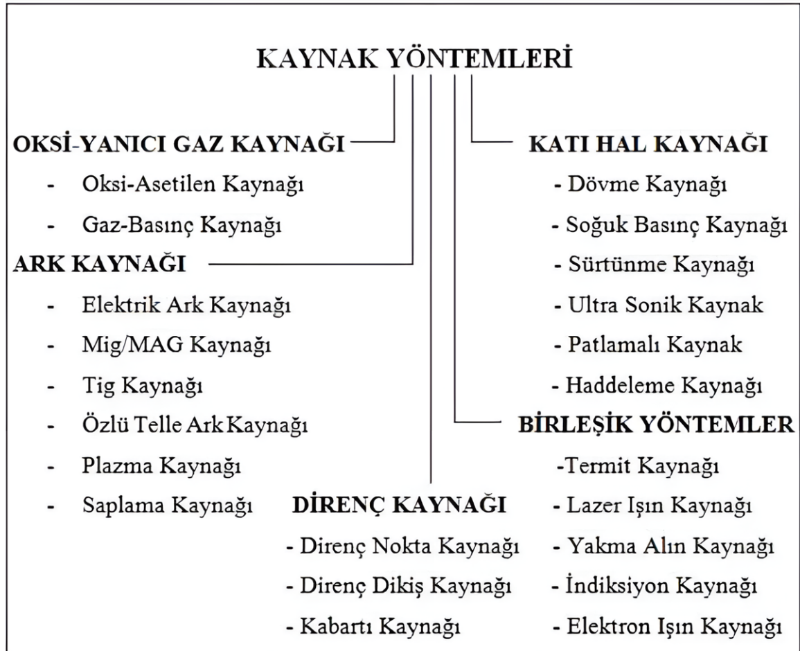
Şekil 2.1. Kaynak yöntemleri (Anık 1991)
