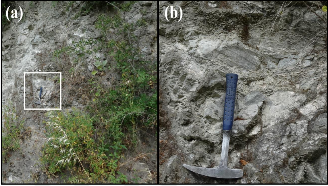
Şekil 3.4. Çalışma sahasındaki mikaşistlerin (a) genel görünümü, (b) belirgin foliasyonlarını gösterir yakın görünümü. Koordinat: 35T, 0738117D, 04508457K
