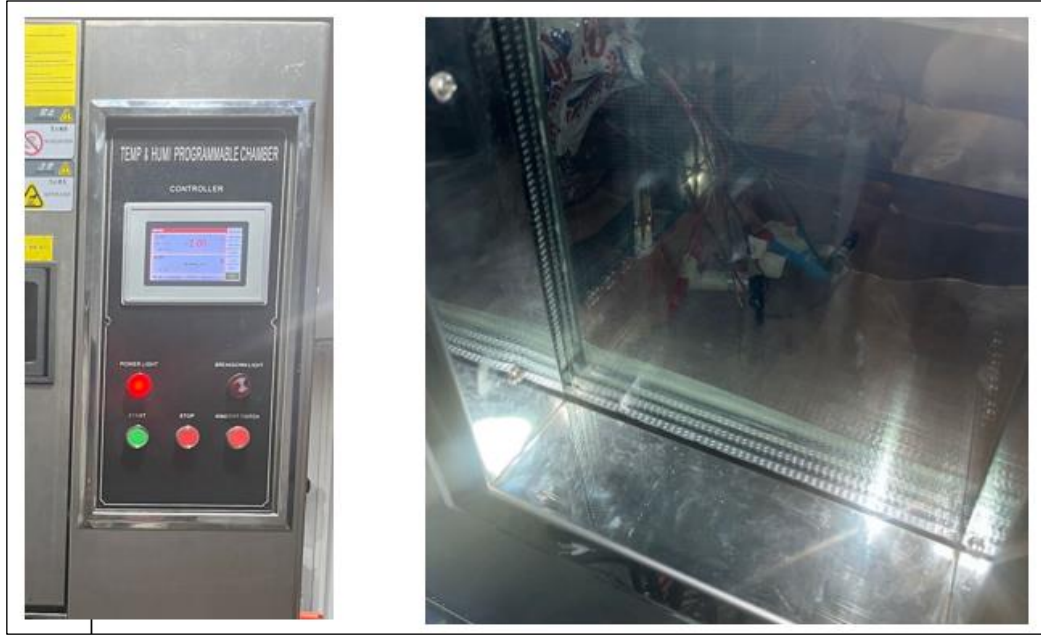
Şekil 5.3: Test aşamasında chamber ve kontrol panelinin görüntüsü.
