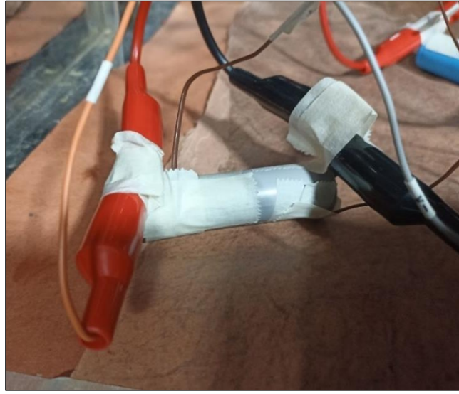
Şekil 5.4: Testler için hücreye yerleştirilen termokupl düzeneği.
