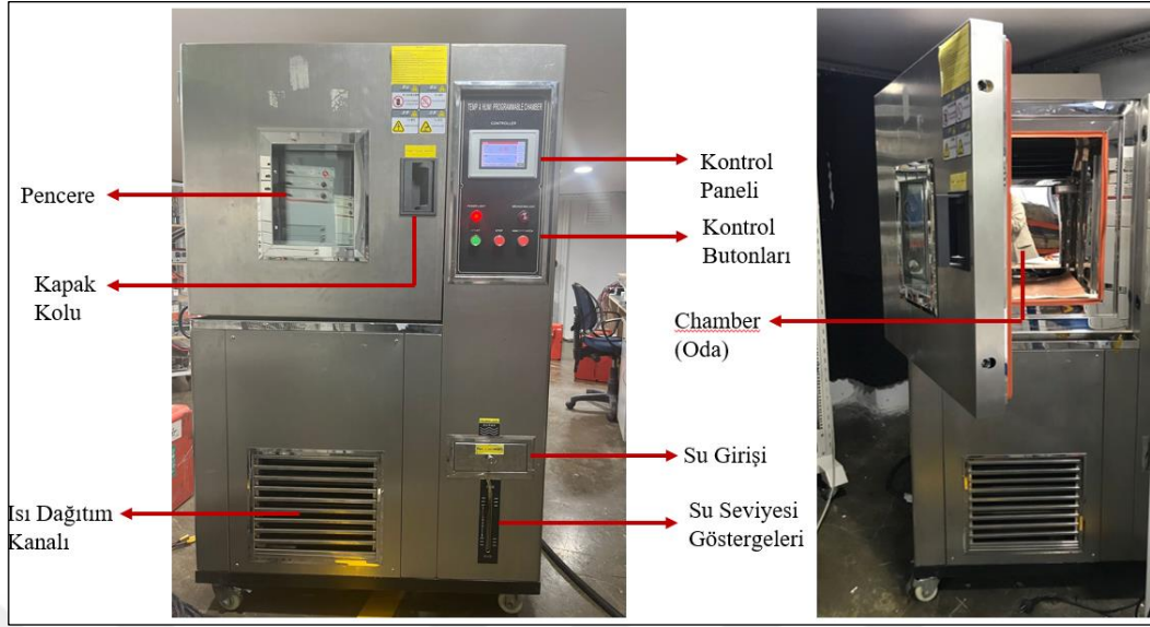
Şekil 5.2: Farklı sıcaklık testleri için programlanabilir sıcaklık-nem odası.
