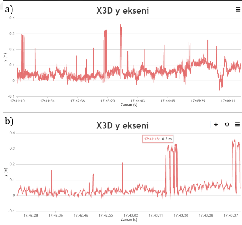
Şekil 5.15. Deney süresince X3D dosya formatına uygun a) yüzeyin yükseklik bilgisinin izlendiği grafiğin ve b) seçilen bölgenin daha ayrıntılı gösterimi
