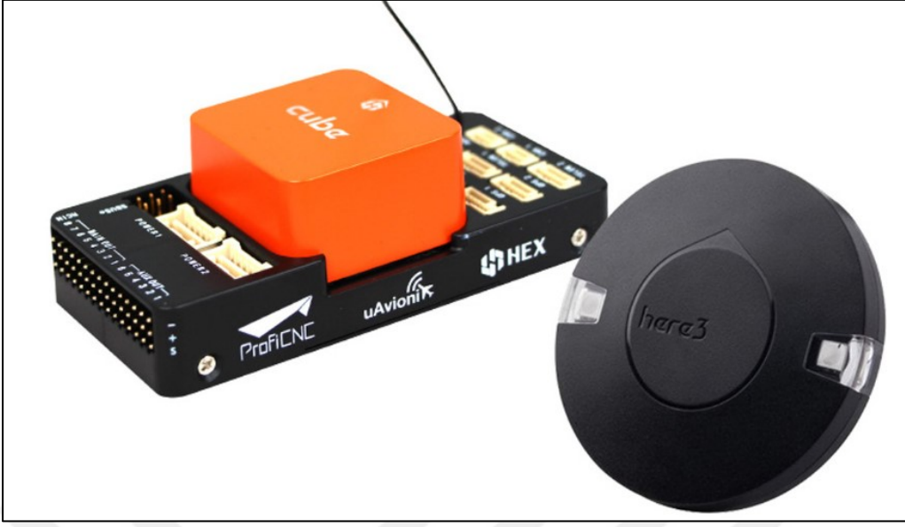
Şekil 3.10. Pixhawk Cube Orange+Here3+ otopilot uçuş kontrol kartı
