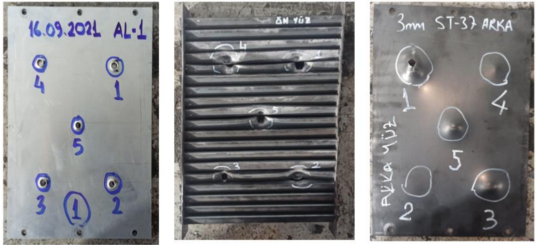
Şekil 5.2 : Birinci numunede görülen hasarlar
