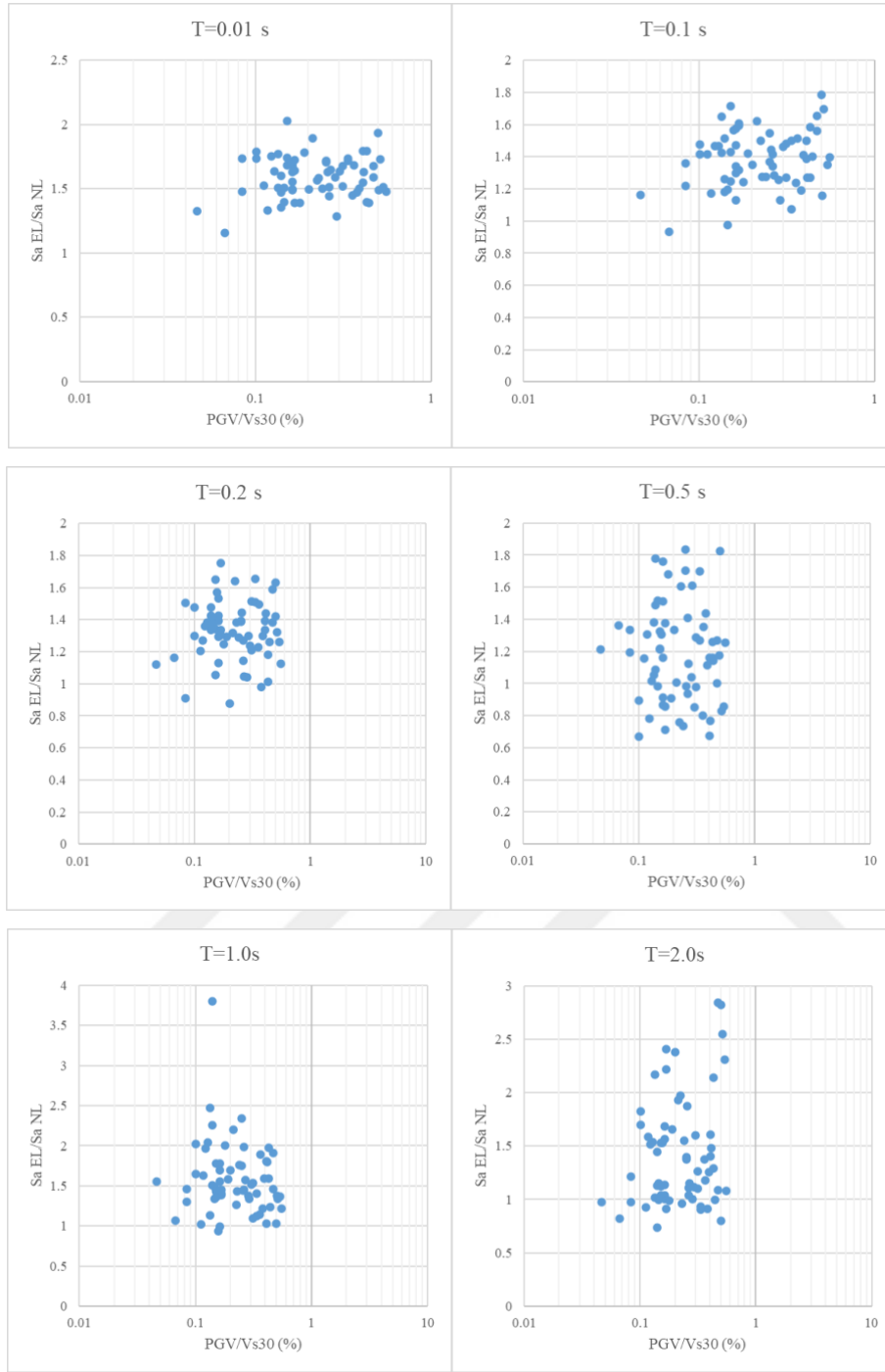
Şekil 4.13. DD-2 için ( T=0.01, 0.1, 0.2, 0.5, 1, 2 sn.) spektral periyotlar için S_a(EL) / S_a(NL) oranının tahmin edilen kayma birim deformasyonu indeksine ( I_\gamma = PGV/V_{s,30} ) göre değişimleri
