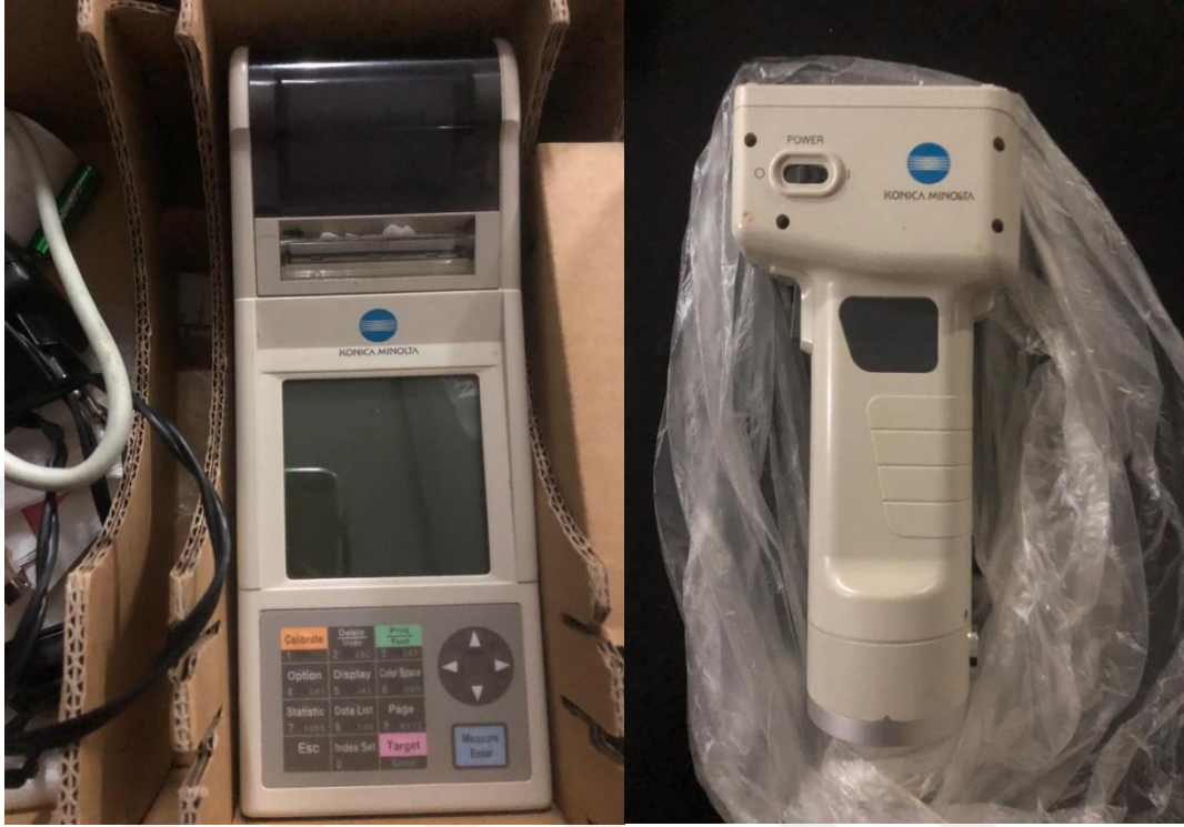
Resim 3.18. Yaprakta renk ölçümü yapan kromometre (MİNOLTA CR-400)
