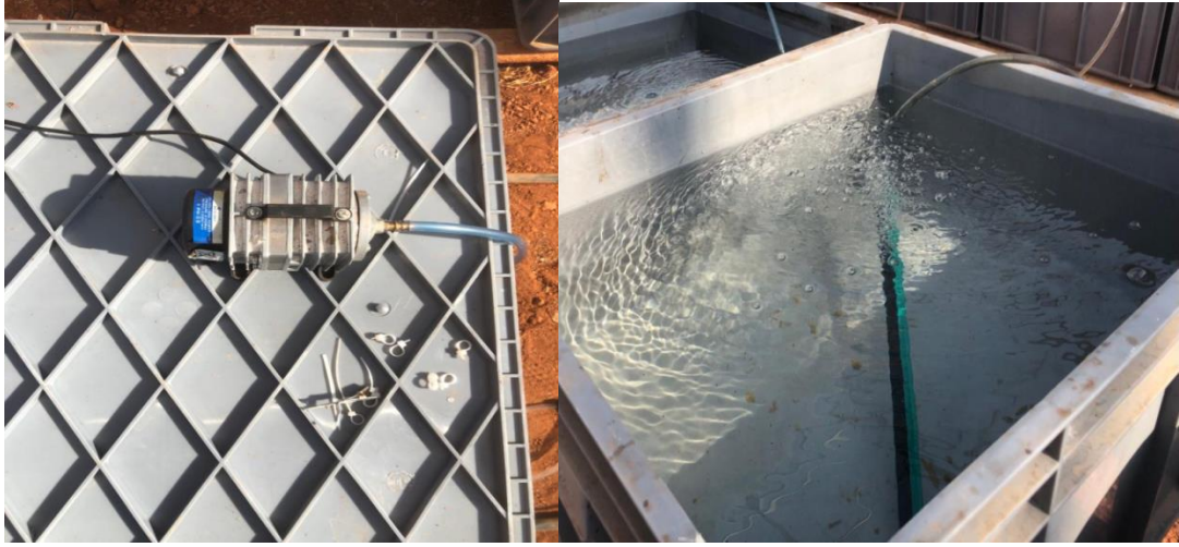
Resim 3.6. Araştırmada kullanılan havalandırma düzeneği
