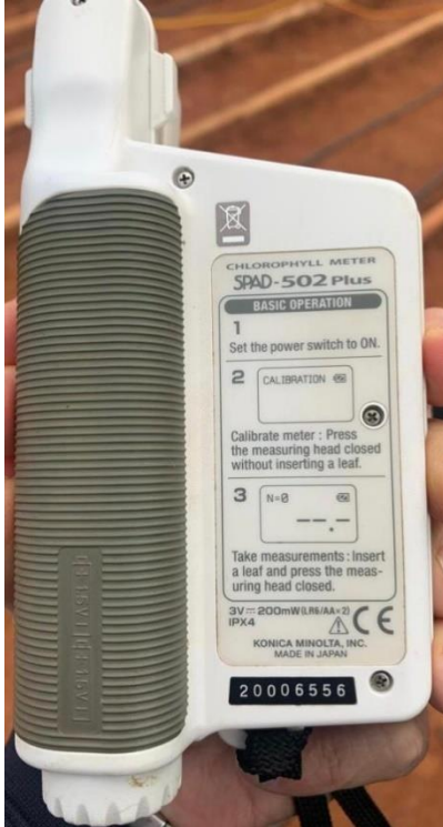
Resim 3.17. Marul yapraklarında klorofil ölçümü yapan Konica minolta (SPAD-502)
