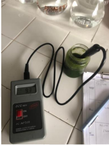
Resim 3.14. Marul yaprak suyunda EC ölçümü
