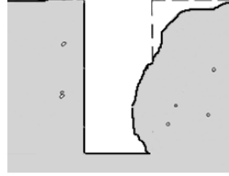
(2) Kazı yüzeyinde kabarma oluşumu
