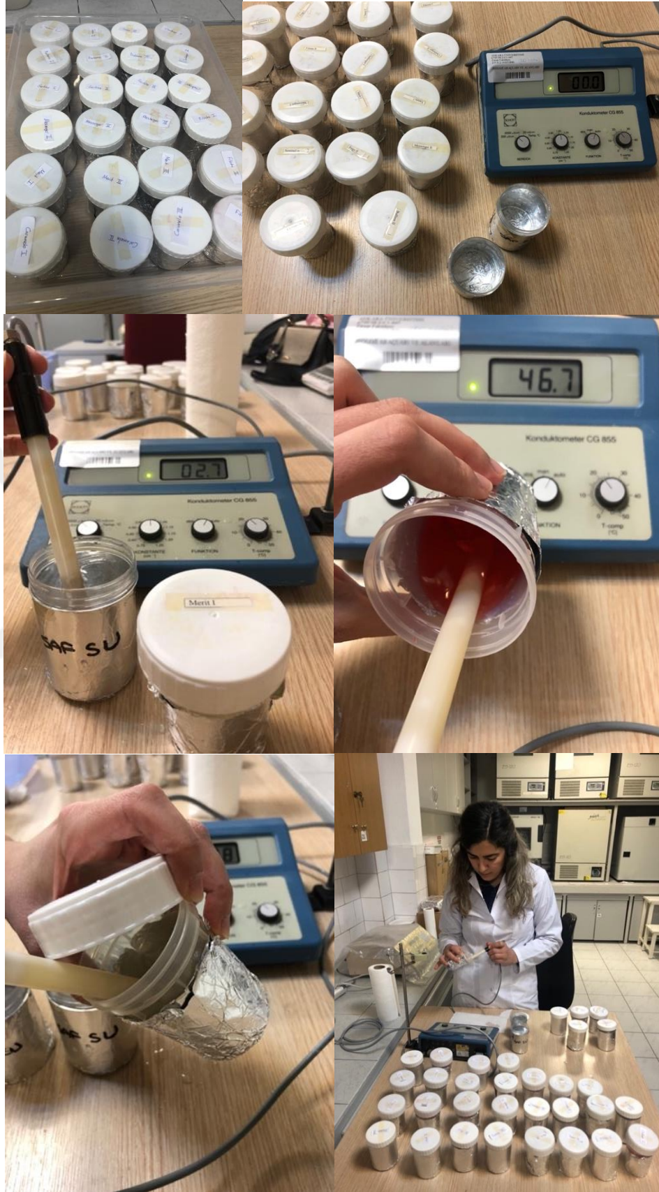
Şekil 3.12 Elektriksel iletkenlik testi ölçümünden görüntüler
