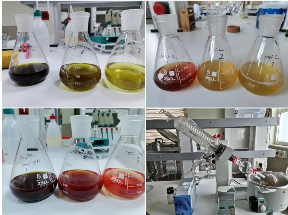
Şekil 3.4. Hazırlanan ekstreler için örnekler ve rotavoporda solvent uzaklaştırma
