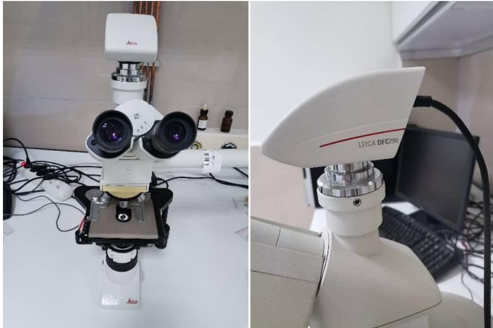
Şekil 3.2. Anatomik ve palinolojik çalışmalarda kullanılan ışık mikroskobu ve kamera sistemi
